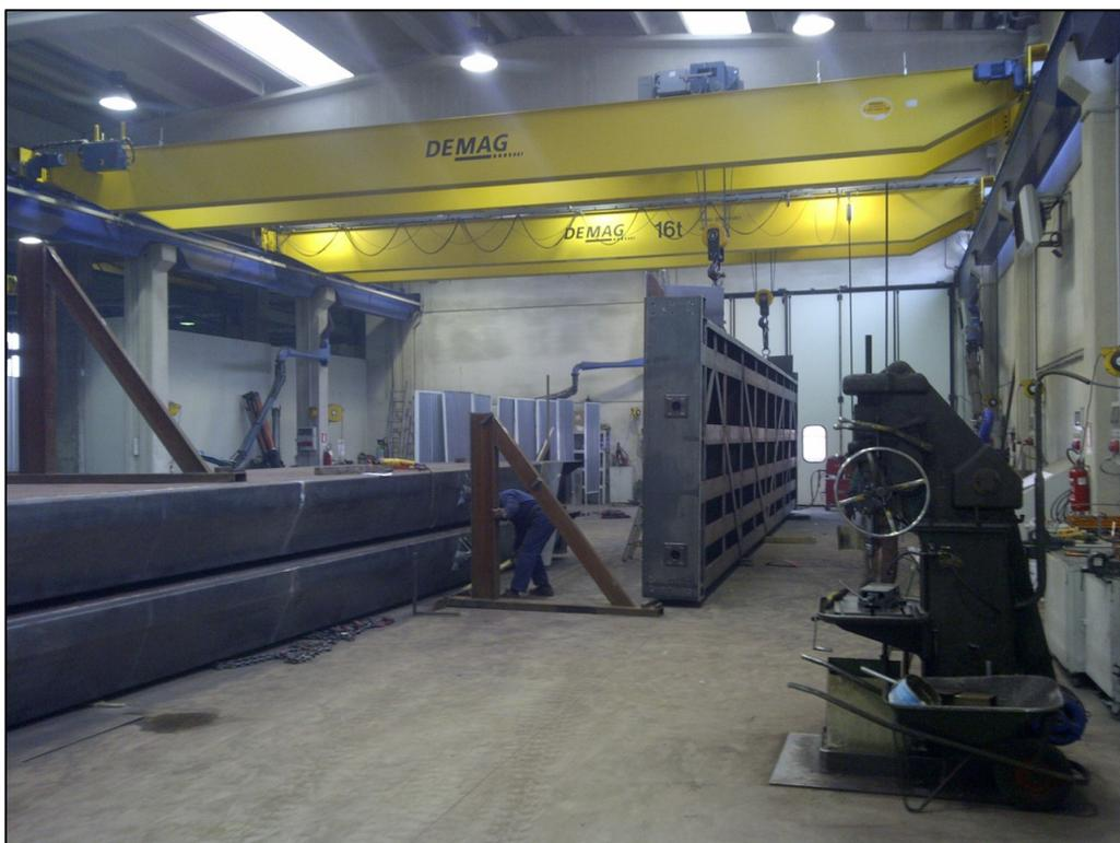
Figura 16: Realizzazione di una paratoia in stabilimento. Fonte: Bianco SRL (2018).
