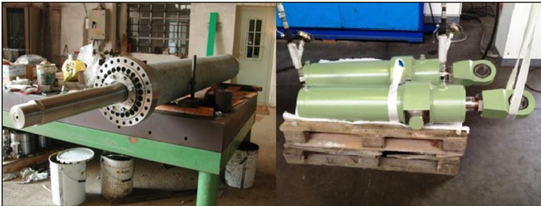
Figura 11: Esempi di cilindri e pistoni per sistemi di sollevamento oleodinamici. Fonte: Wet Hydro SRL (2018).
