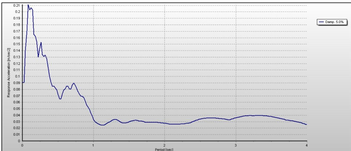
Figura 147: Spettro elastico di risposta in accelerazione, registrazione 357.
