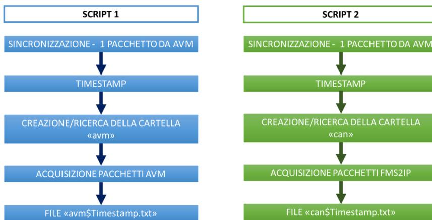
Figura 3-23: Schema a blocchi degli script di acquisizione dall’AVM e dal FMS2IP.
