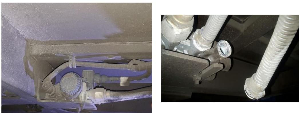
Figura 3-43: Attacco del tubo pneumatico all'elettrovalvola, prima dell'installazione dei sensori.
