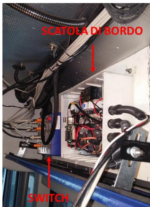
Figura 3-50: Vano dopo l'installazione della scatola conta-passeggeri.
