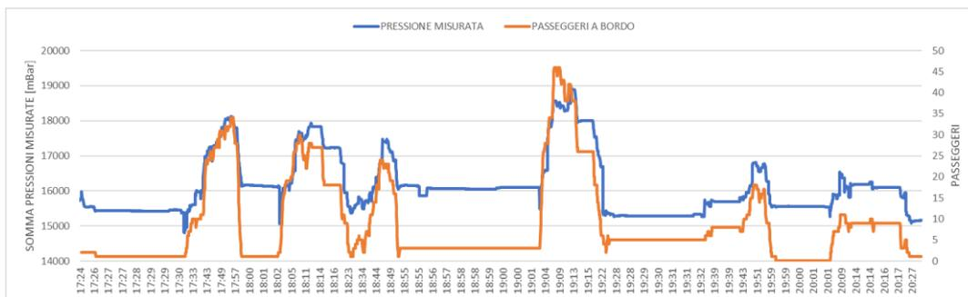
Figura 4-6: Grafico relativo ai dati analizzati nella giornata 11-07-2018, durante la terza raccolta, sulla linea 6.
