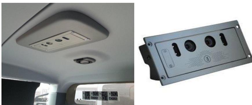
Figura 1-10: Esempi di telecamere stereoscopiche. (SELSAT s.d.) (Eurotech s.d.)
