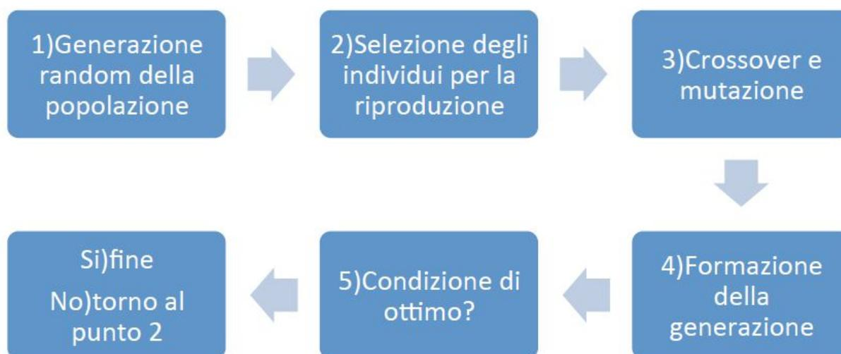
Figura 66 - Schema di funzionamento di un algoritmo genetico
