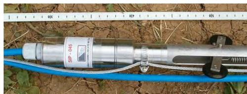
Figura 5 – Inclinometro fisso da foro
