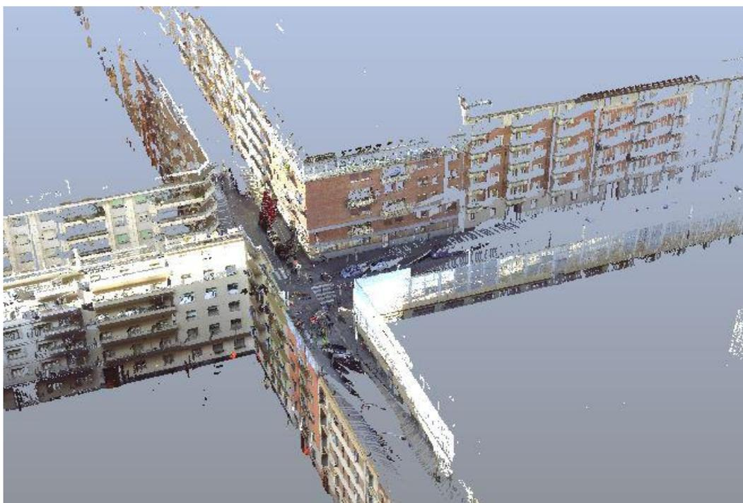
**Figura 3.12 La nuvola dei punti della intersezione completa ottenuta tramite Scene**
