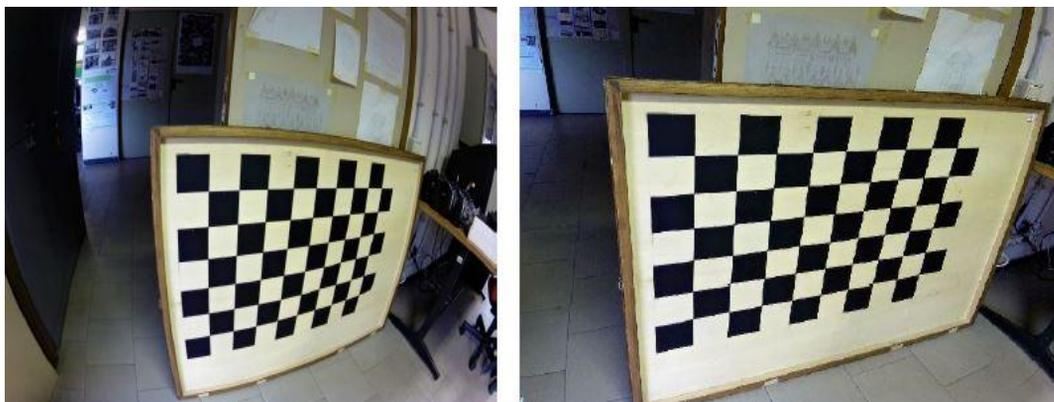
**Figura 2.12 Correzione della distorsione**
