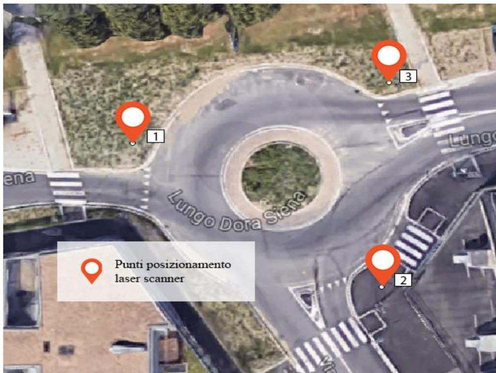
**Figura 3.6** Punti in cui sono effettuate le scansioni con laser scanner
