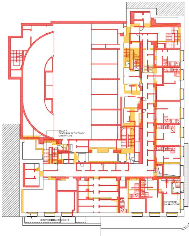
**2.02** Schema demolizioni-costruzioni P-1.
