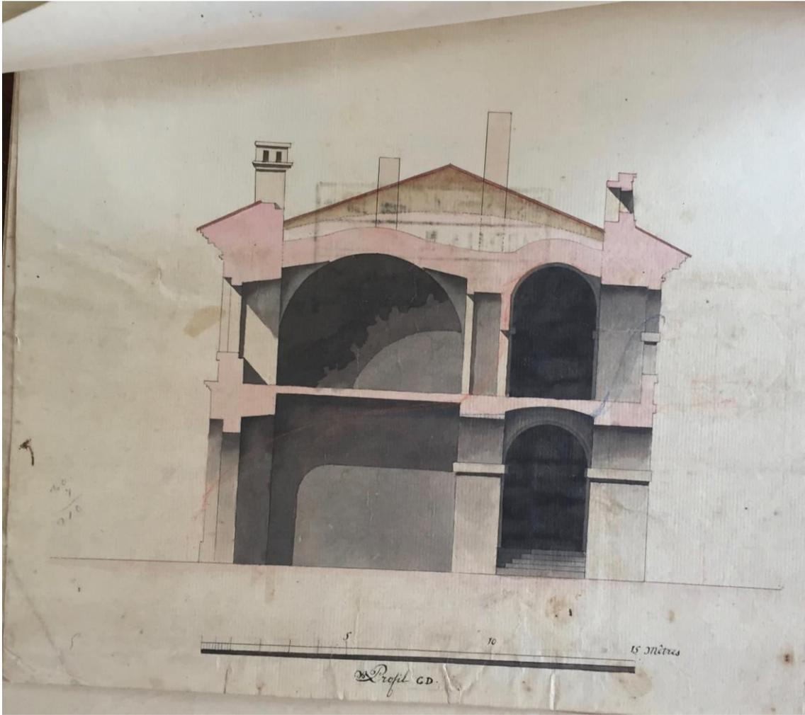
Img. 8. XIX secolo. Sezione C-D. Si tratta probabilmente della sezione dello stato di fatto.
