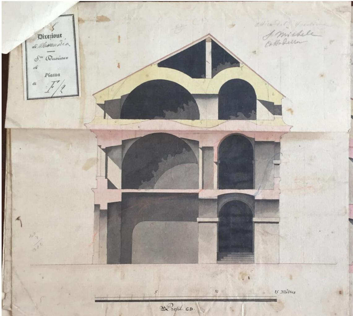
Img. 9. XIX secolo. Sezione C-D. Si tratta probabilmente della sezione dello stato di progetto. ISCAG.
