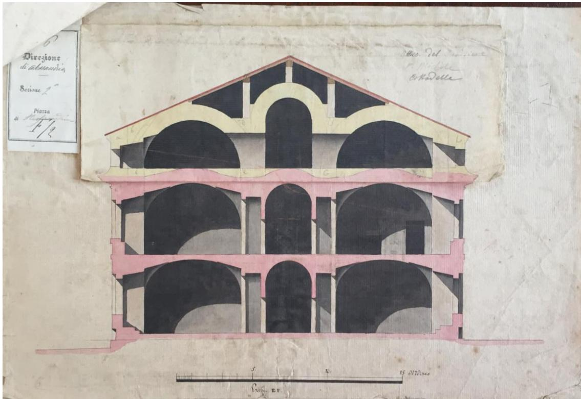
Img. 11. XIX secolo. Sezione E-F. Si tratta probabilmente della sezione dello stato di progetto.
