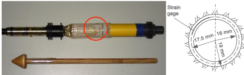
*Figura 51: Illustrazione di una generica cella triassiale CSIRO (in evidenza una delle tre rosette estensimetrica) e della sua sezione trasversale esemplificata.*
