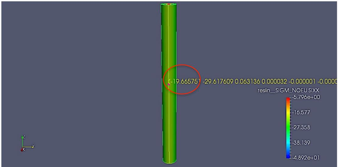
Figura 20: Stato tensionale radiale esterno
