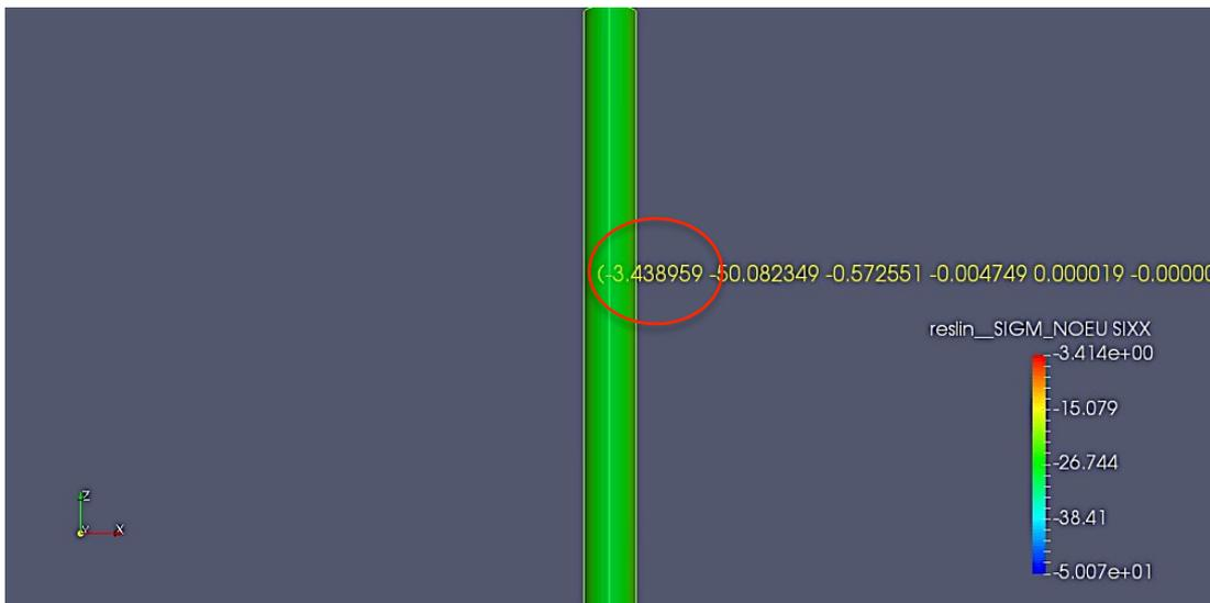
Figura 23: Stato tensionale radiale interno
