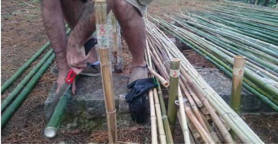
Figura 195. Taglio della canna sotto il nodo appartenente all'internodo più rettilineo e più vicino alla base.
