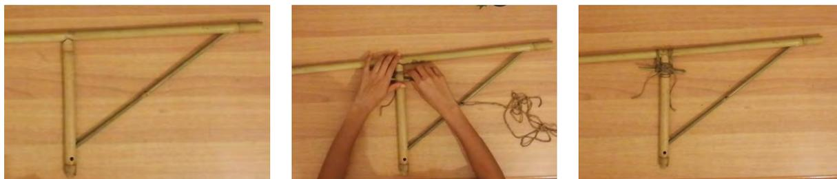
Figura 441. A sinistra. Asticella di bambù inserita nei fori della canna orizzontale e di quella verticale.
