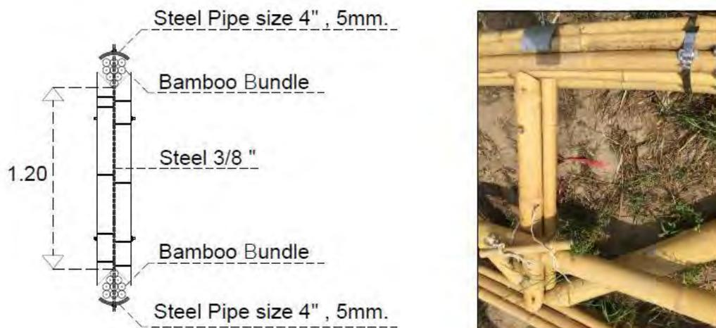
Figura 87. Dettaglio D1 della connessione in chiave tra il corrente inferiore e quello superiore, con interasse di 1,20 metri. Il montante è costituito da due canne connesse tra loro da filetti in bullonati alle estremità, tra le canne vi è un tondino filettato di 3/8" che attraversa sia il fascio superiore che quello inferiore, fissato da piastre metalliche curvate alle estremità dei fasci. Nell'immagine a destra si nota la fascetta metallica che lega le canne del fascio.
