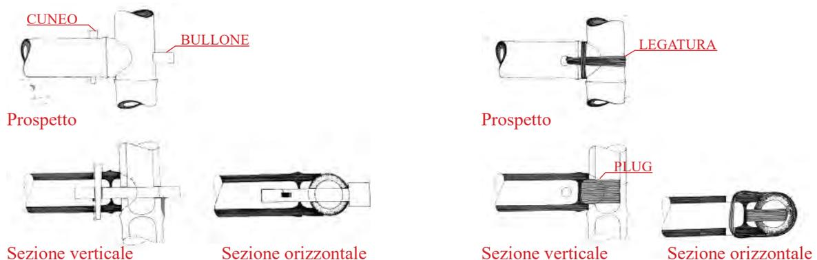
Figura 133. A sinistra. Giunto con bullone e cuneo di legno, in S. GASS, op. cit., p. 120.
