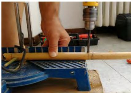
Figura 439. A sinistra. Foro perpendicolare alla canna, utile per l’inserimento dello spinotto.
