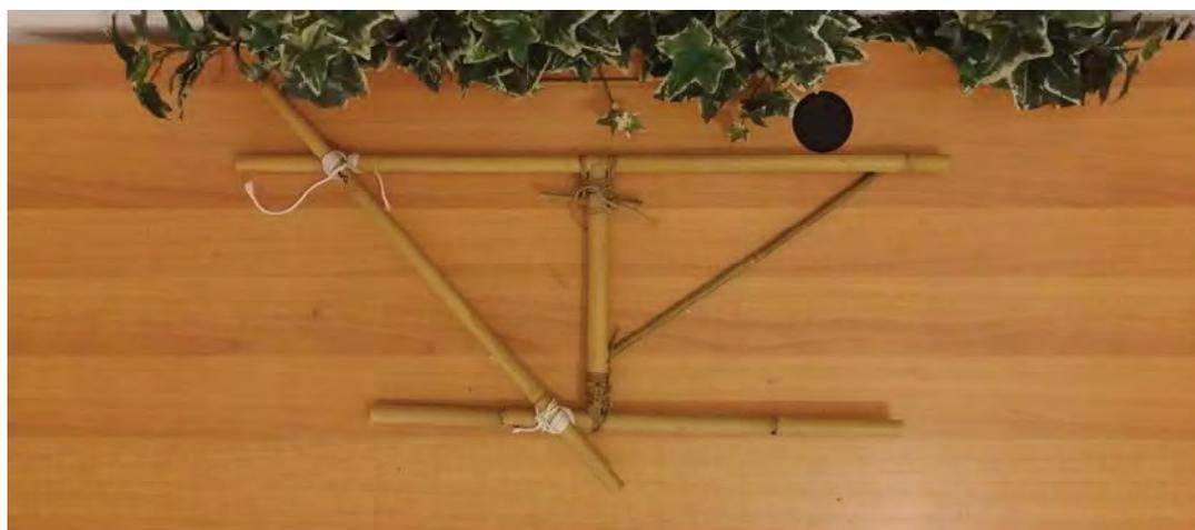
Figura 452. Soluzioni finali per il sistema di connessione tra aste orizzontali-verticali-oblique.
