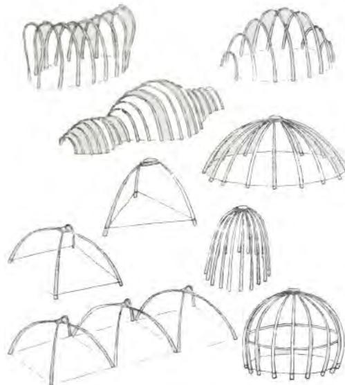
Figura 51. Archi o sistema di archi di diverse lunghezze e con curve caratterizzate dai vari piani di forma ellittica, circolare, triangolare e quadrata, in S. GASS, op. cit., p. 308.
