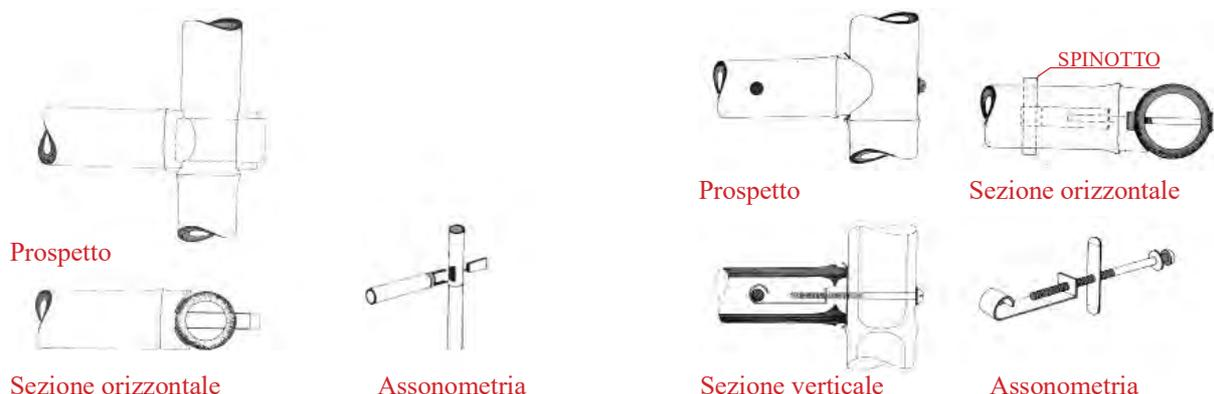
Figura 135. Giunto con tenone, mortasa e cuneo, ibid., p. 151.
