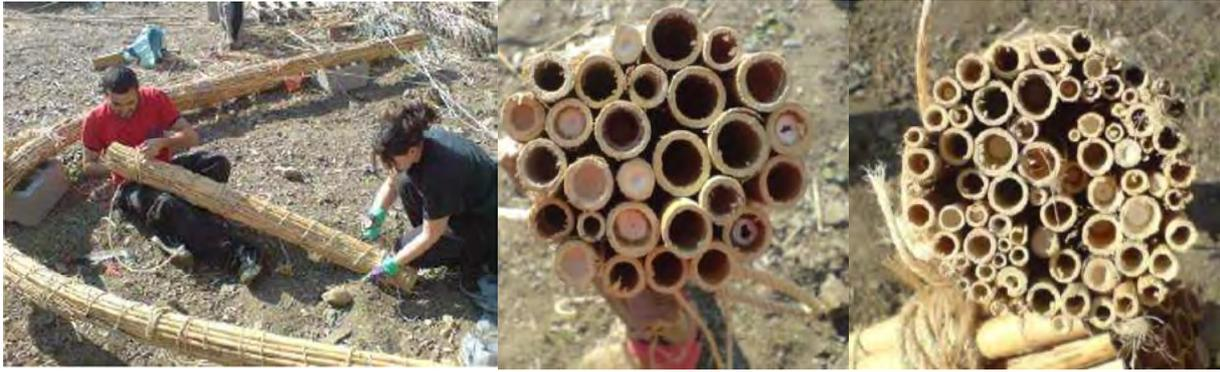
Figura 341. A sinistra. Provino di lunghezza 1,5 m ottenuto dalla sezione di un fascio, <https://investigaciocanyera.wordpress.com>, consultato il 21/04/2018.
