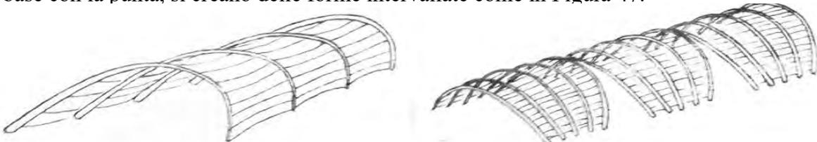
Figura 46. A sinistra. Sistema di archi paralleli. A destra. Sistema di archi inclinati. In S. GASS, op. cit., p. 306.
