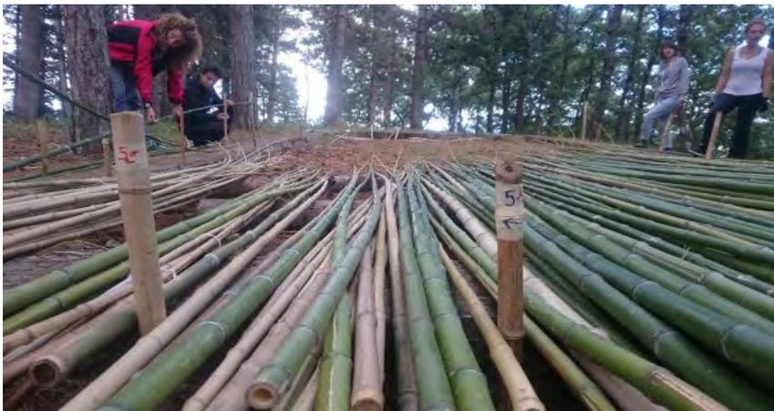
Figura 199. Paletti del classificatore posizionati sul lato corto che indicano la lunghezza della canna (5 m) e il senso di torsione (orario; antiorario).
