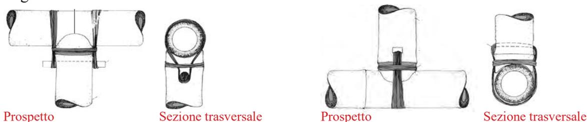
Figura 444. Confronto tra le legature possibili tra elementi perpendicolari giacenti sullo stesso piano. La legatura di sinistra è stata realizzata per la connessione tra montante e corrente superiore; la legatura di destra è stata realizzata per la connessione tra montante e corrente inferiore
