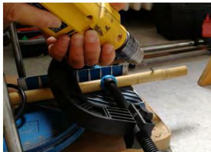
Figura 440. A destra. Foro obliquo utile per l’inserimento dell’asticella in diagonale.
