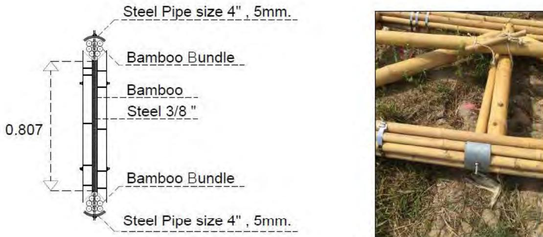
Figura 88. Dettaglio D2 della connessione tra i due fasci, con interasse di 0,8 m. Tra il corrente inferiore e quello superiore. Il montante è costituito da due canne connesse tra loro da due filetti inbullonati alle estremità, tra le canne vi è un tondino filettato di 3/8" che attraversa sia il fascio superiore che quello inferiore, fissato da piastre metalliche curvate alle estremità dei fasci. Nell'immagine a destra si nota la fascetta metallica che lega le canne del fascio.
