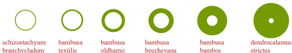
Figura 16. Spessore della parete dei culmi di bambù di diversa specie.
