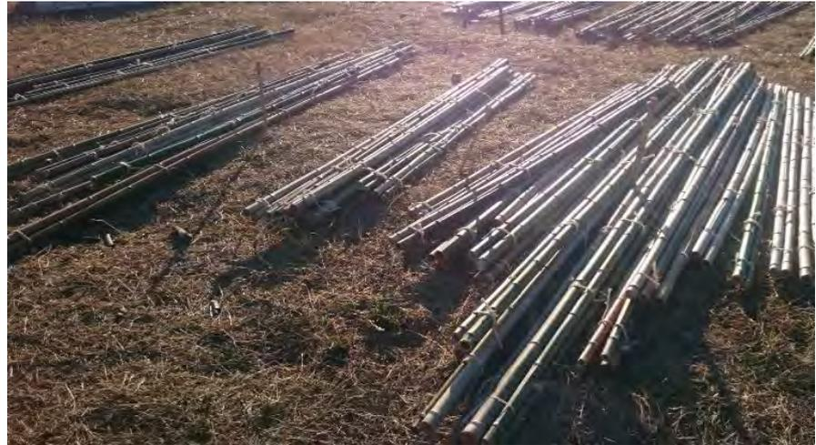
Figura 276. A sinistra. Fasci costituiti da coppie di canne di bambù, aventi lo stesso diametro.
