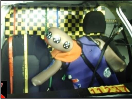
Figura 5-21: analisi video: escursione della testa per la 1° prova Palo.
