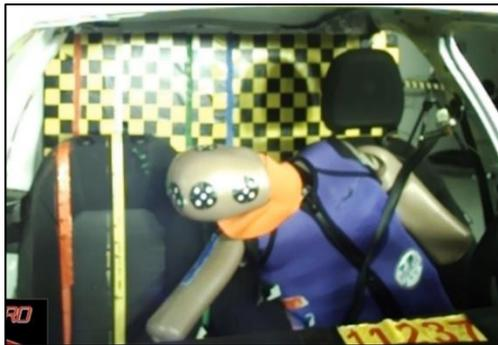
Figura 5-26: analisi video: posizione orizzontale della testa per la 1° prova Palo.
