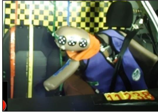
Figura 5-22: analisi video: escursione della testa per la 1° prova AE-MDB.
