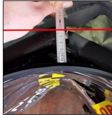
Figura 6-10: intrusione su pannello porta nel caso in cui si verifica il distacco dalla struttura esterna.
