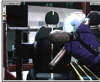
Figura 6-3: simulazione urto Far Side con un Advanced Center bag.
