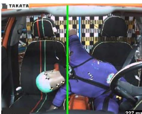
Figura 6-5: simulazione urto Far Side in presenza della console centrale e in assenza di airbag centrale [33].
