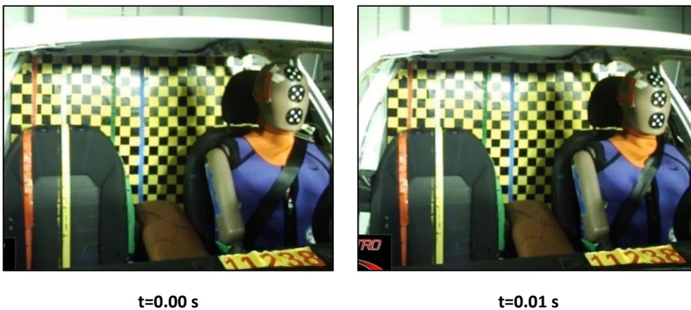
Figura 5-16: analisi video: valutazione TTF per la 1° prova AE-MDB.
