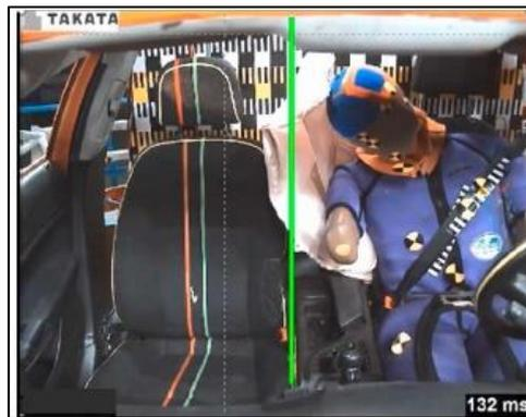
Figura 6-8: simulazione urto Far Side in presenza della console centrale e dell'airbag centrale [33].
