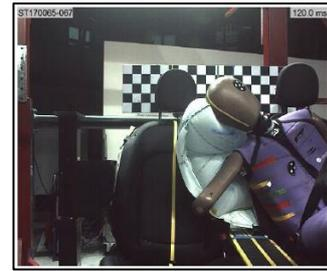
Figura 6-4: simulazione urto Far Side con un Pillow Bag.
