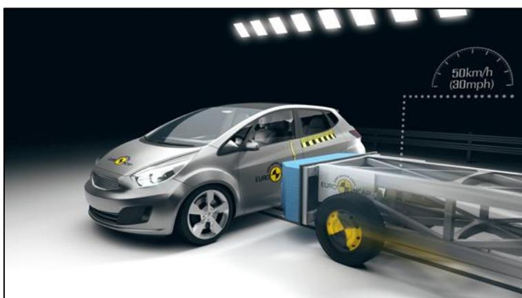
Figura 2-4: urto laterale contro barriera deformabile [13].
