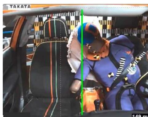
Figura 6-6: simulazione urto Far Side in presenza della console centrale e dell'airbag centrale [33].
