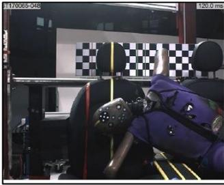
Figura 6-2: simulazione urto Far Side in assenza di Airbag centrale.
