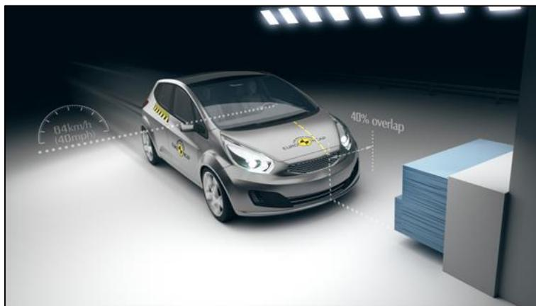
Figura 2-2: test frontale disassato [13].
