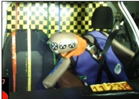
Figura 5-27: analisi video: posizione orizzontale della testa per la 1° prova AE-MDB.
