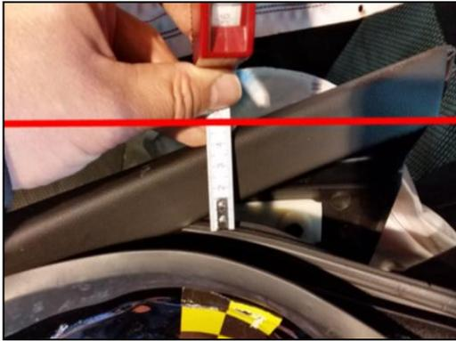
Figura 6-9: intrusione su pannello porta nel caso in cui non si verifica il distacco dalla struttura esterna.
