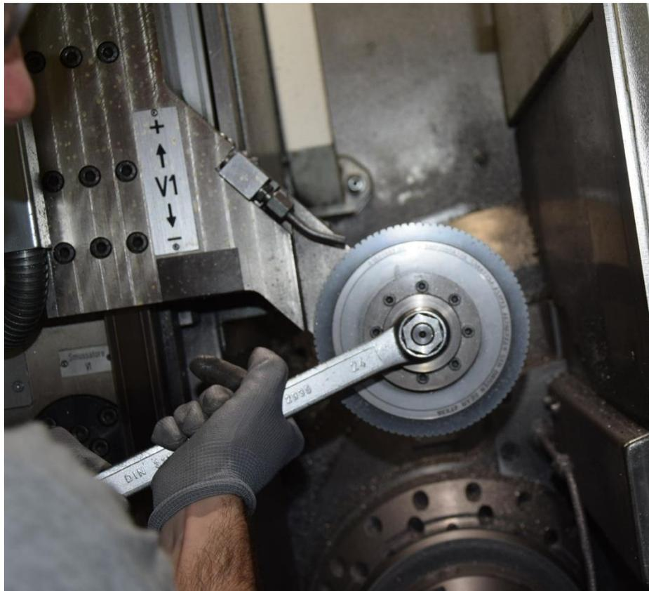
*Figura 56 – Sostituzione Coltelli*
