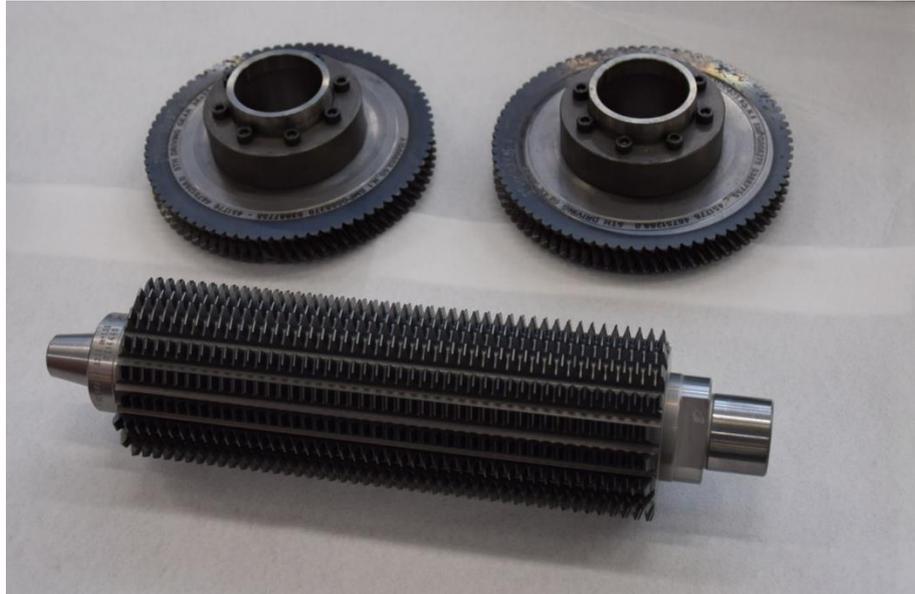
Figura 49 – Utensili da sostituire nel cambio tipo
