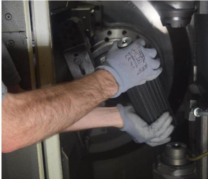
*Figura 55 – Sostituzione Creatore*
