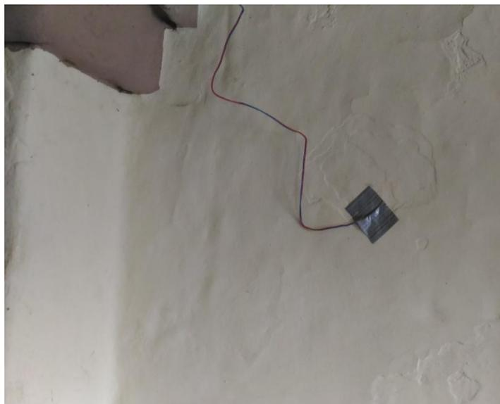
Figura 29: sensore temperatura superficiale parete rivolta a Est
