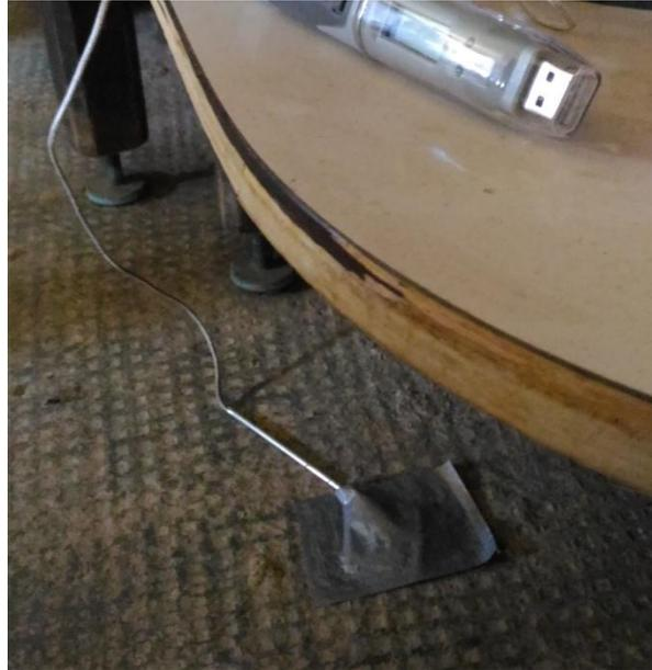
Figura 28: sensore temperatura pavimento
