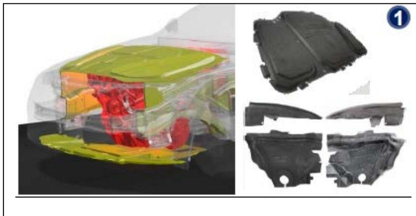
*Figura 30 Esempio di incapsulamento della vettura*
