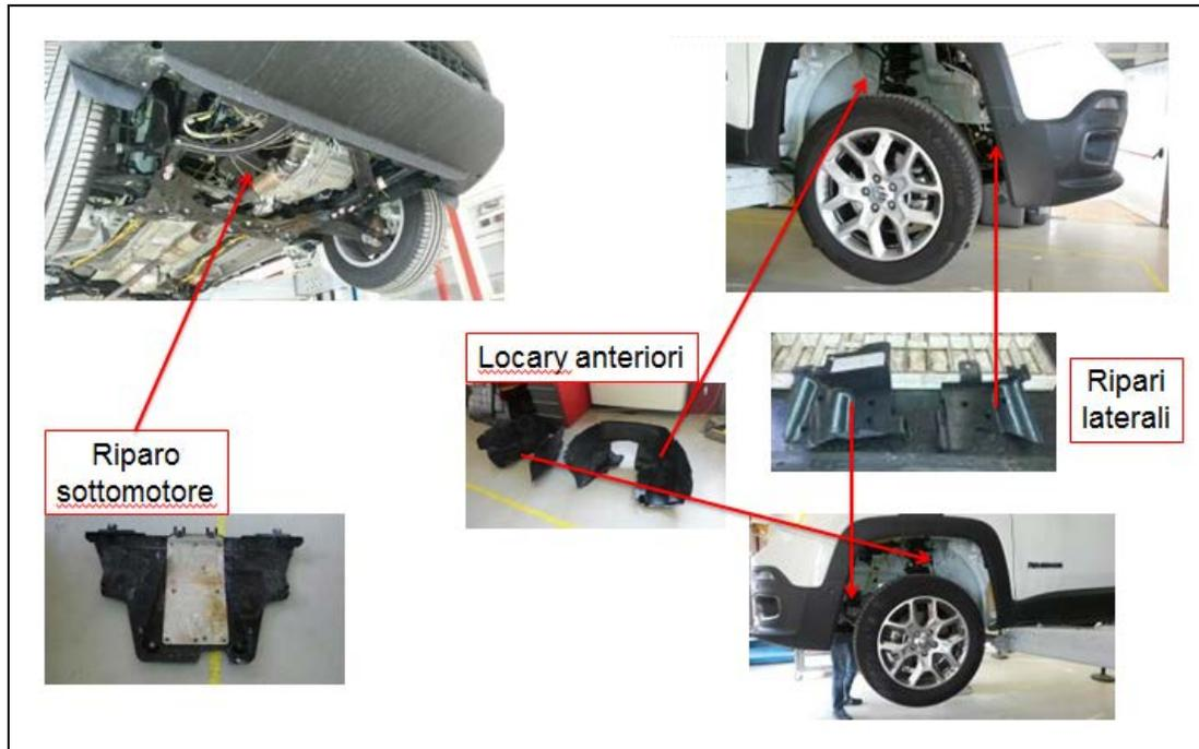
Figura 39 Elementi eliminati per passare dalla versione incapsulata a quella non incapsulata
