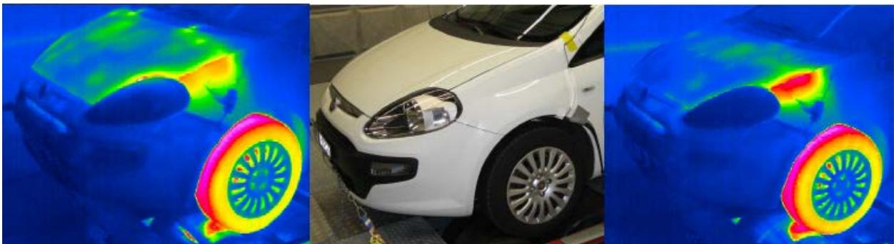
*Figura 21 Esempio su Fiat Punto di engine encapsulation (prima e dopo)*
