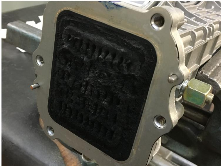
**Figura 7.2** Residui carboniosi all'interno dell'*EGR cooler*
