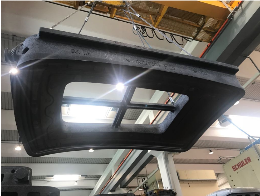
Stampo in ghisa sollevato per mezzo di un carroponte
