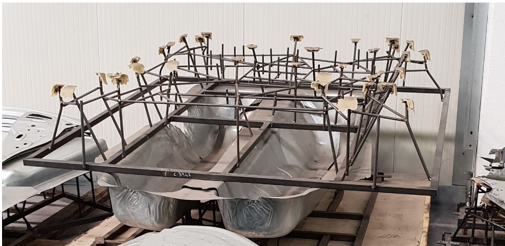
Pallet per il taglio laser 3D
