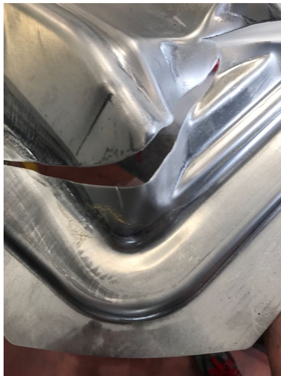
Rottura per scarso scorrimento del materiale
