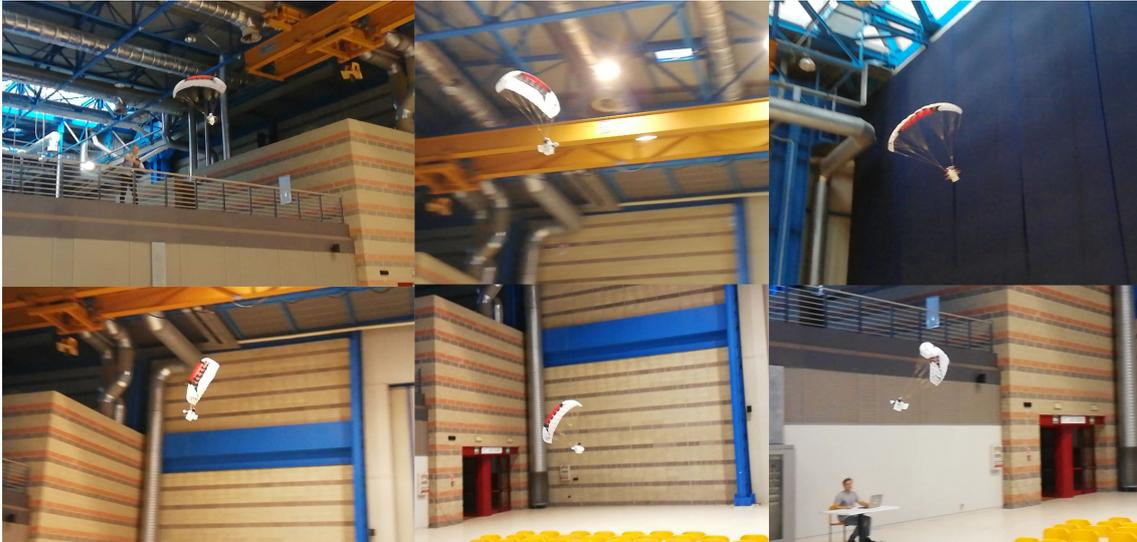
*Figura 5.9: Primo test a chiuso. Si notano, in ordine da sinistra in alto, il lancio, la stabilizzazione, una prima manovra di virata di 180° verso sinistra, una seconda virata verso destra, perdita di quota e avvicinamento all'atterraggio.*
