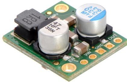
Figura 2.4: Il regolatore di tensione di tipo step-down utilizzato nella nostra configurazione. Senza di esso non potremmo alimentare in maniera corretta il Raspberry.
