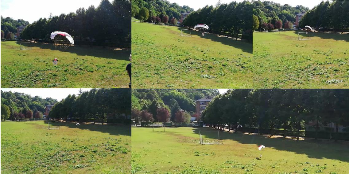
*Figura 5.10: Test all'aperto svolto il 26 agosto 2018. La sonda, lanciata da un piccolo colle, acquisisce velocità e si stabilizza. Viene manovrato in remoto, facendo qualche virata di 180° per poi tornare verso il punto di lancio. Non riuscendo ad acquisire quota, atterra in una zona intermedia (nell'immagine in basso a destra).*
