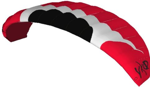
*Figura 2.1: Il Parafoil utilizzato è della ditta francese Opale Paramodels, ed è un Opale Oxy 0.5. Il massimo peso che può sopportare è di 0.3 kg.*
