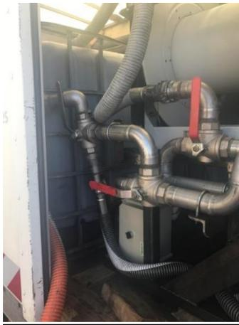
Figura 53 : Photo prototype sur le camion ou la tuyauterie dépasse l'ouverture latéral du camion Veolia
