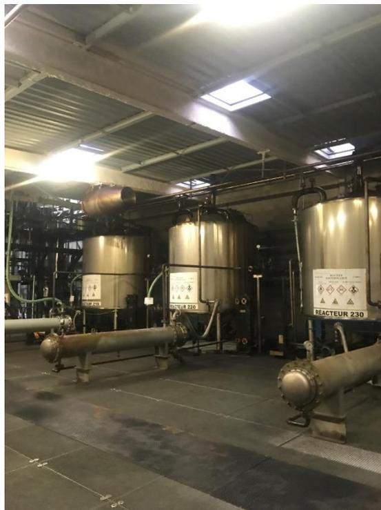
Figura 16 : Photo des 3 reacteurs d'esterification
