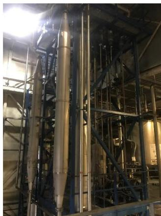
*Figura 21 : columns de distillation du methanol*
