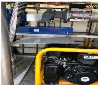
*Figura 92 : capote installé pour protéger le groupe électrogène de l'huile*
