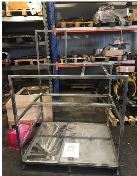
Figura 83 : Photo final du skid réalisé en INOX 304L
