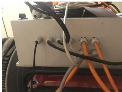
Figura 103 : disposition trou dans la boite pour le passage des fil
