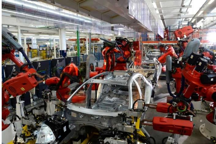
*Figura 30 - Processo di produzione della scocca (Maserati, AGAP)*
