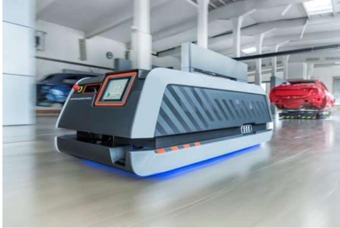
*Figura 32 - Piattaforma mobile a guida autonoma (Audi)*
