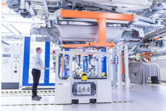
*Figura 33 - Montaggio sottoscocca eseguito da un robot (Audi)*
