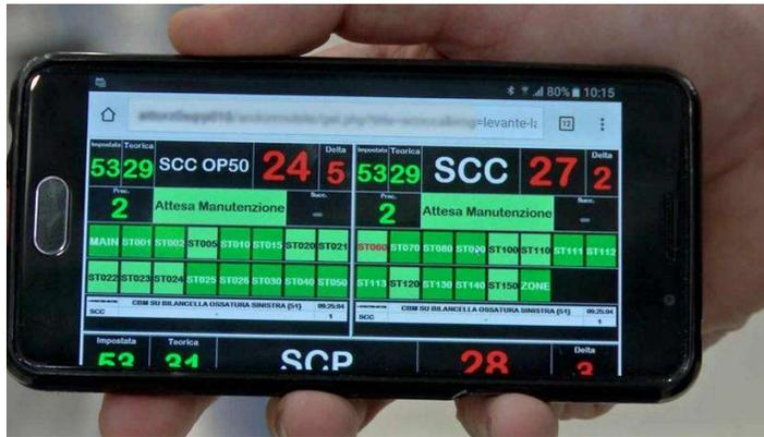
Figura 31 – Esempio di “terminale a bordo linea” (Maserati)
