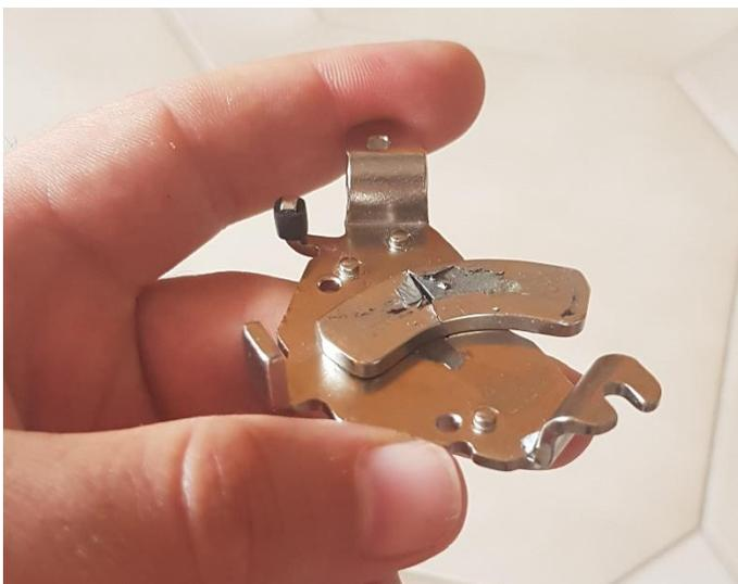
**Figura 2 – Uno dei due magneti del componente voice coil motor scollato dal sostegno metallico ed utilizzato per l’esperimento idrometallurgico**
