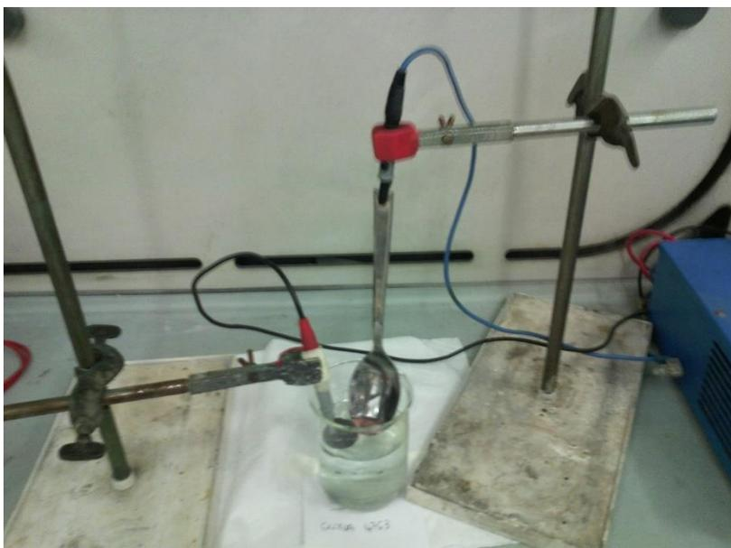
Figura 25 - Apparato per l'elettrodeposizione
