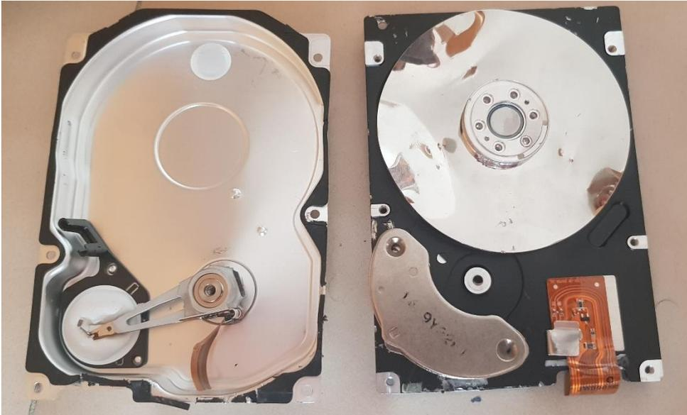
**Figura 1 - Hard disc separato manualmente: in basso a destra il voice coil motor contenente due magneti in NdFeB e lo spindle motor contenente un magnete NdFeB**
