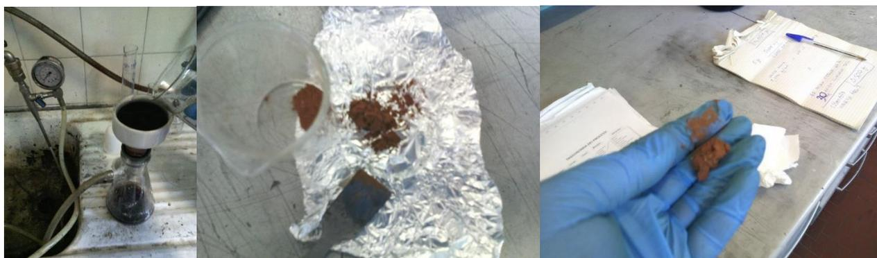
Figura 4 - Fasi di recupero del precipitato e parti residue che non hanno reagito
