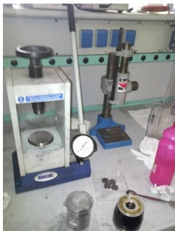
Figura 6 - Pressa idraulica e componenti
