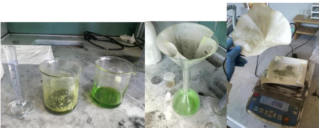
Figura 23 - Diluizione per analisi elementi presenti nella polvere campione
