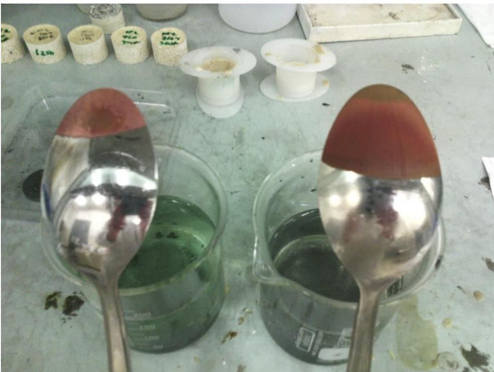
Figura 32 - Deposito della prima prova a sinistra e della terza prova a destra
