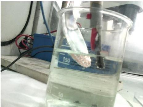
Figura 9 - Particolare reazione dovuta alla produzione di prodotto gassoso agli elettrodi
