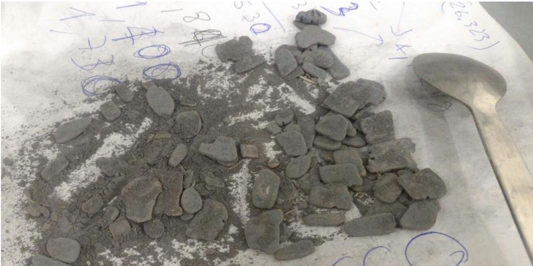
**Figura 21 – Ottenimento di polvere dal campione massivo a seguito della comminazione ad opera del mulino a vibrazione**
