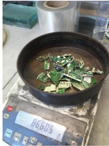
Figura 19 - Operazioni di taglio e sminuzzamento della scheda di circuito elettrico
