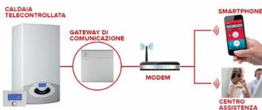
Figura 39. Controllo remoto tramite smartphone
