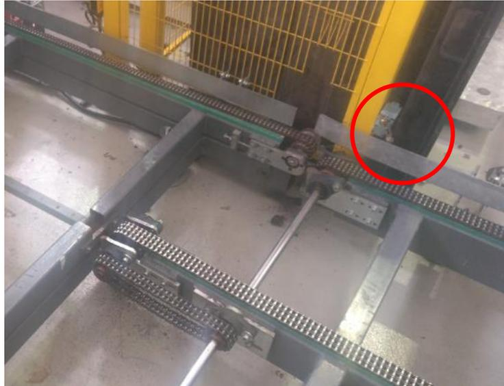
Figura 51. Barriera protettiva e sensore
