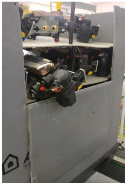
Figura 69. Gruppo idraulico in bilico
