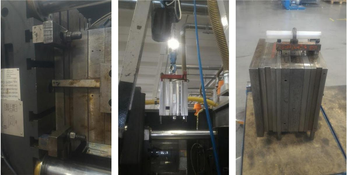
Figure 31. Esempio di sistema di bloccaggio; Sospensione dello stampo con il paranco; Stampo rimosso
