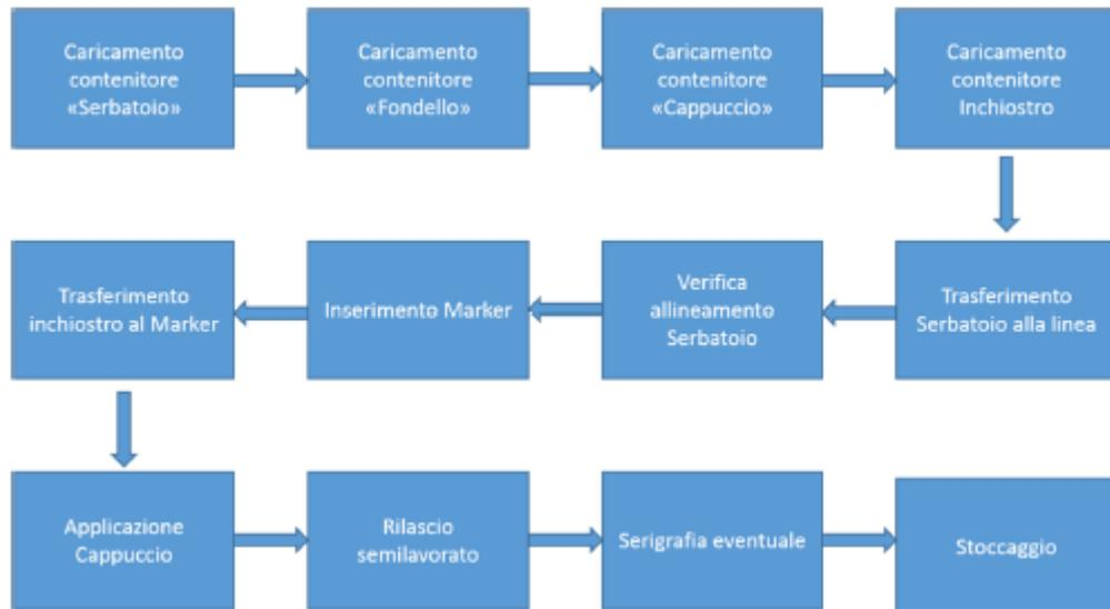
Figura 21. Schema del processo di assemblaggio
