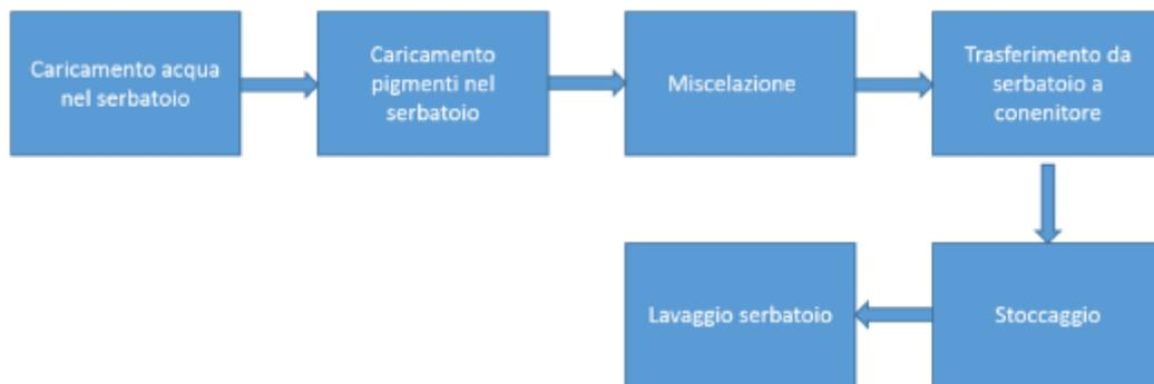
Figura 20. Schema del processo di preparazione degli inchiostri
