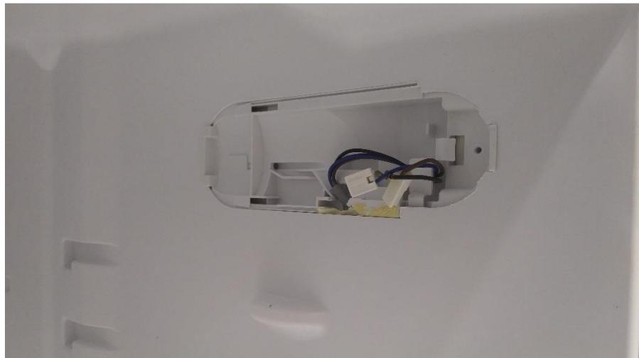
Nell'immagine è possibile vedere una cella intatta in prossimità della contro-scatola del termostato grazie all'utilizzo del coperchietto che è già stato rimosso per l'applicazione del termostato meccanico.
