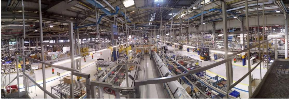
Il resto dei componenti, quali compressori, termostati, componenti elettroniche, imballaggi etc. provengono da fornitori. Per quanto riguarda i condensatori, vengono prodotti nel piano inferiore della fabbrica con l'ausilio di presse meccaniche.
