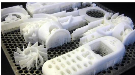
Figura 21. Stereolitografia SLA
