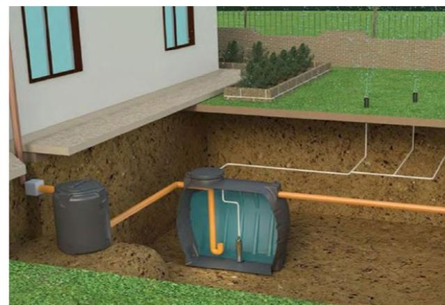
Le acque grigie invece sono opportunamente trattate primariamente in vasche di calma interrate per permettere la separazione per flottazione delle sostanze galleggianti, operazione necessaria per garantire le condizioni ottimali di funzionamento ai successivi trattamenti di depurazione biologica.
