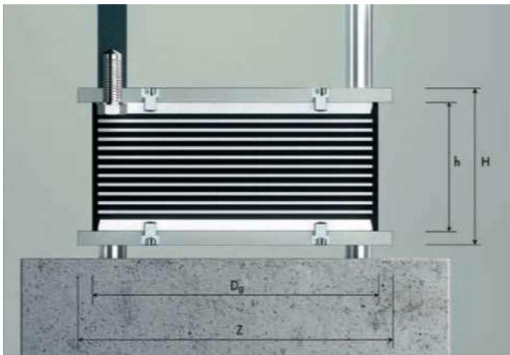
**Figura 52** Sezione dell'Isolatore elastomerico
