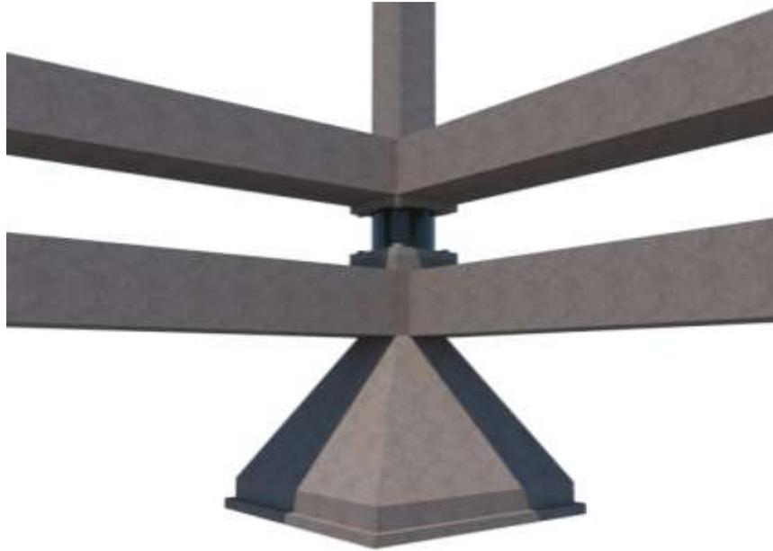
**Figura 129** Elaborazione 3d della posizione dell'isolatore tra i cordoli esistenti 30 x 40 e il nuovo grigliato 35 x 50
