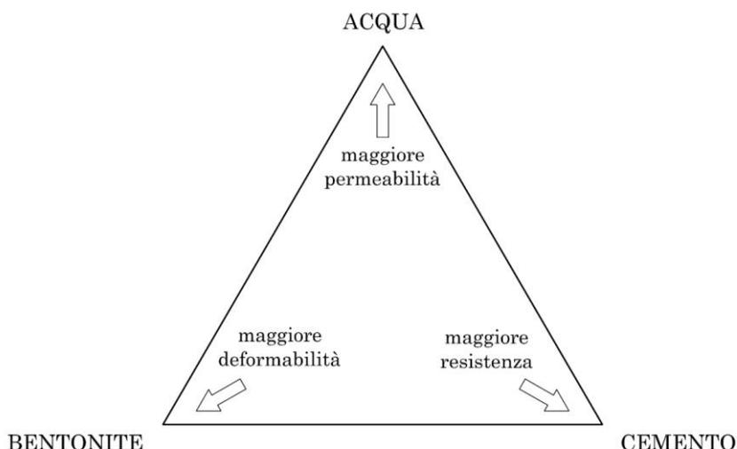
Fig. 1.10: Caratteristiche idrauliche e meccaniche in funzione del dosaggio dei componenti (Manassero 1993)
