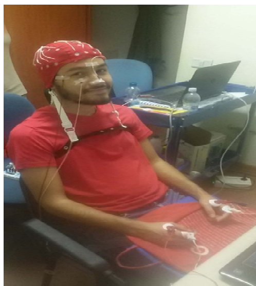
Fig 6: Soggetto sotto esame. Si possono gli elettrodi relativi al segnale EOG (2, occhio destro), riferimento (1, naso), EMG bipolare (4, mani)
