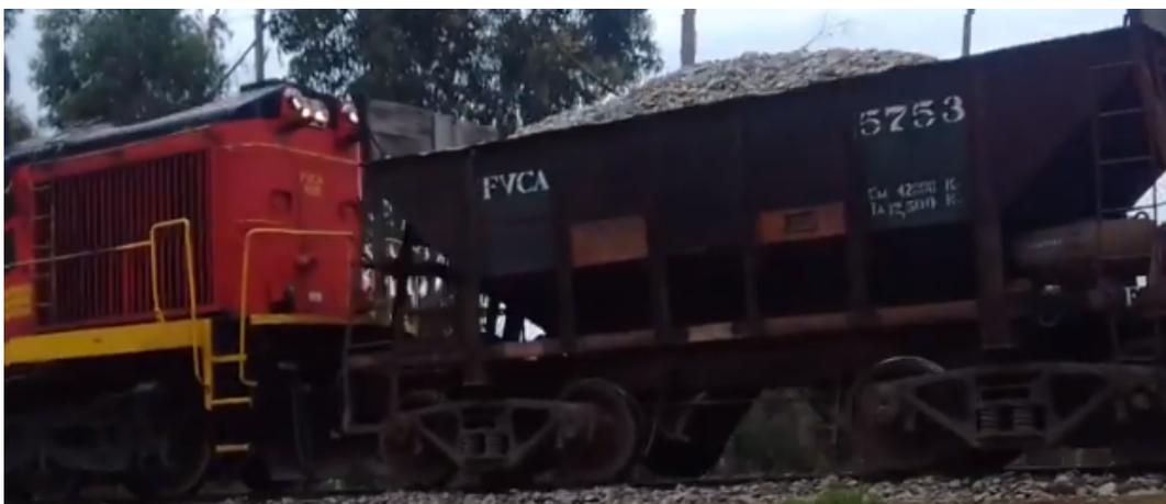
Figura 2.17: Carico massimo:42,000kg–Tara:12,500kg. Totale: 54.5t(14t/asse).
