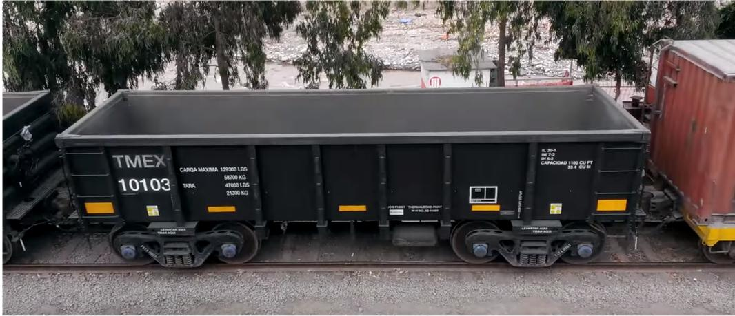
Figura 2.18: Carico massimo:65,000kg–Tara:24,400kg. Totale: 89.4t(22.5t/asse).
