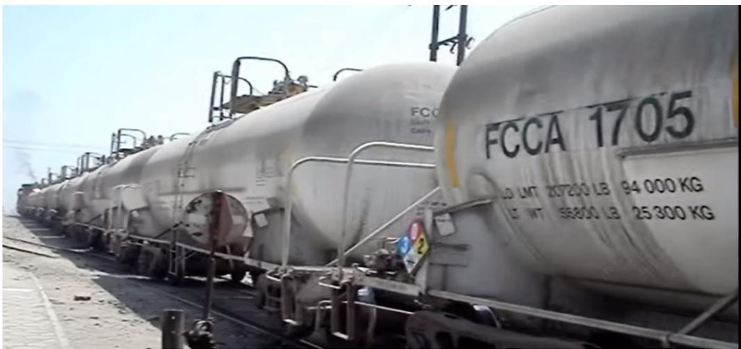
Figura 2.19: Carico massimo:94,000kg–Tara:25,300kg. Totale:119.3t(30t/asse).
