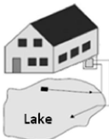
Figura 1.22: sistema open loop con sfruttamento di laghi sotterranei (Karytsas S.2017)
