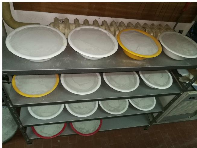
Figura 3.6: polvere lapidea fine inferiore a 125  $\mu\text{m}$  (foto autoprodotta)
