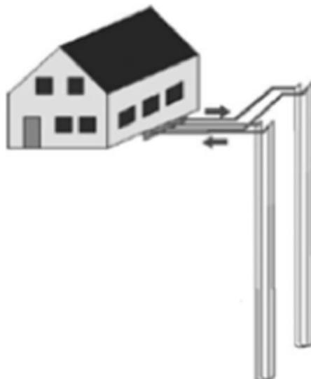
Figura 1.24: sistema di geoscambio close loop, sonde geotermiche verticali (Karytsas S. 2017)
