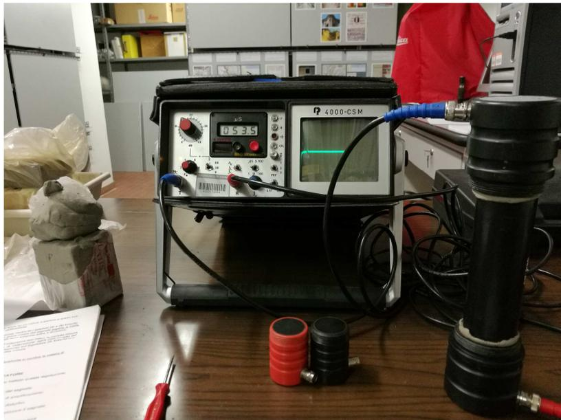
Figura 3.53: calibrazione macchina agli ultrasuoni (foto autoprodotta)
