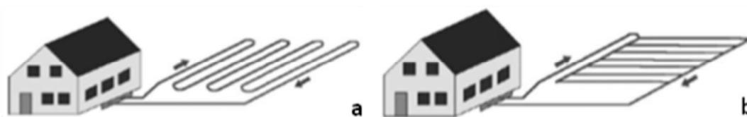
Figura 1.25: sistema di geoscambio close loop, sonde geotermiche orizzontali parallele (a) e in serie (b) (Karytsas S.2017)
