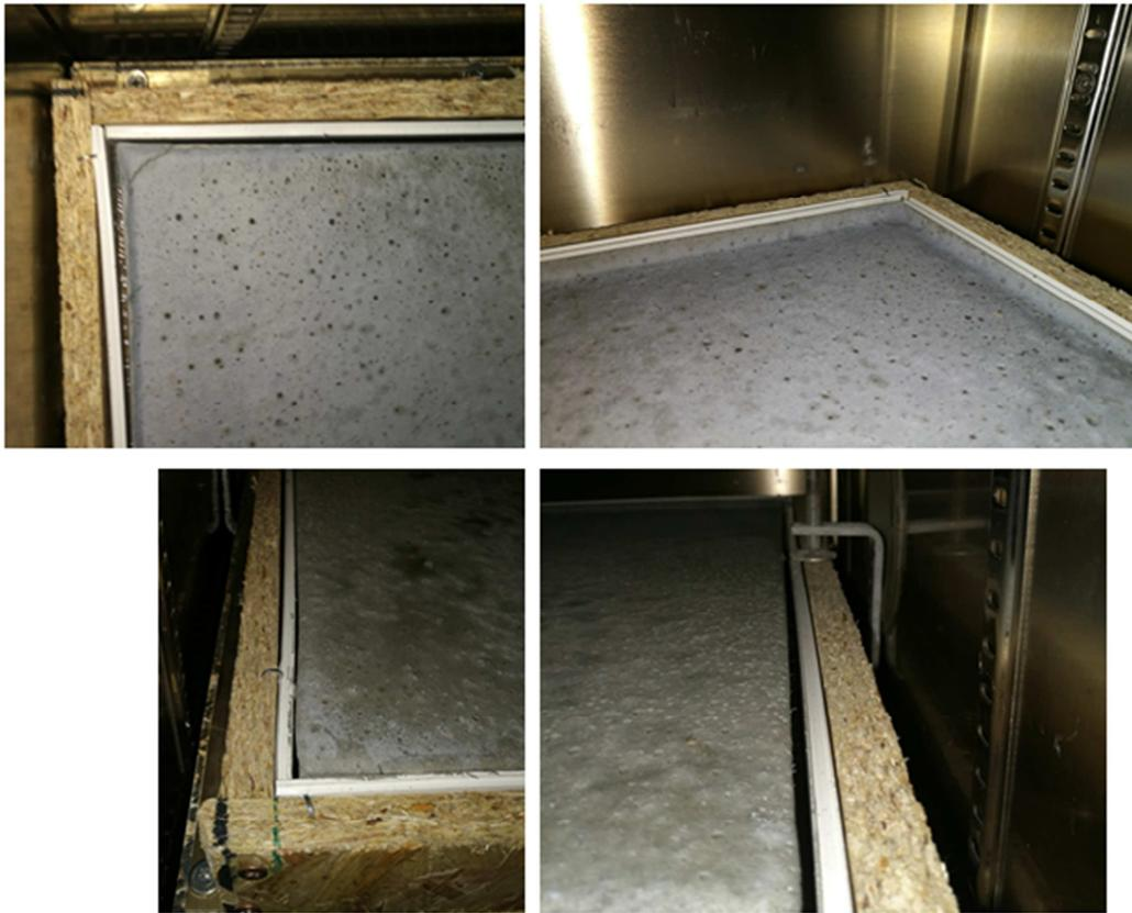
Figura 3.21: ritiro volumetrico, campioni miscela n. 2 (foto autoprodotta)
