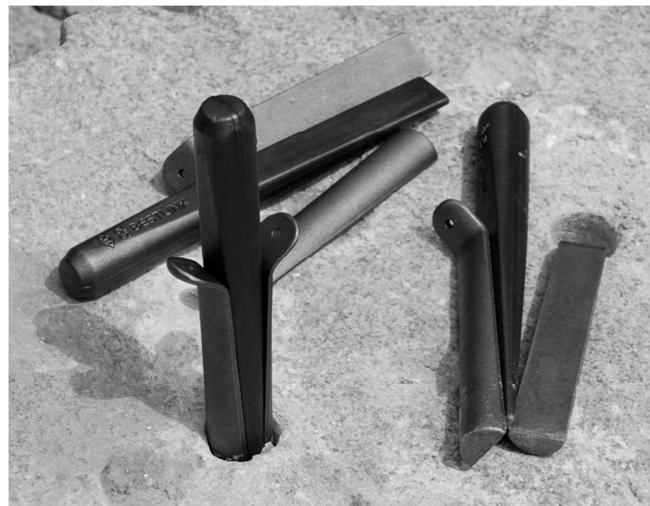
Figura 2.1: cunei e tasselli utilizzati per la separazione dei blocchi di roccia in cava (<http://drystonegarden.com>)
