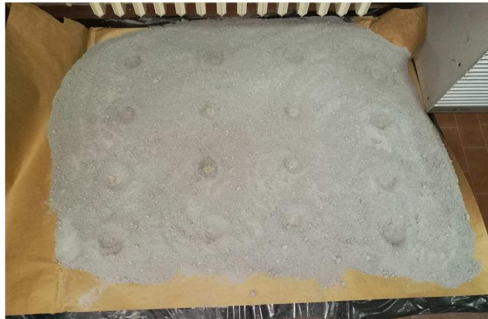
Figura 3.5: fase di essiccazione del materiale lapidea (foto autoprodotta)
