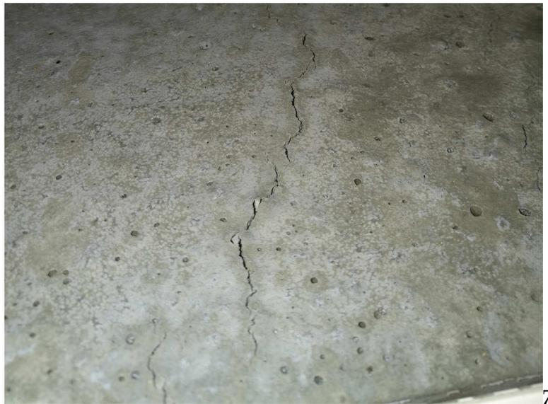
Figura 3.22: ritiro volumetrico, campioni miscela n. 2 (foto autoprodotta)
