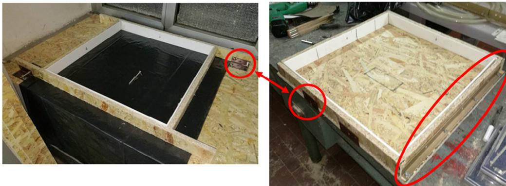
Figura 3.2: cassero per campione geopolimerico, prototipo 1 a sinistra e prototipo 2 a destra (foto autoprodotte)
