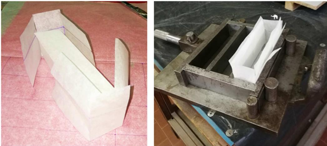
Figura 3.36: carta da forno per mantenere separato materiale e cassero (foto autoprodotta)
