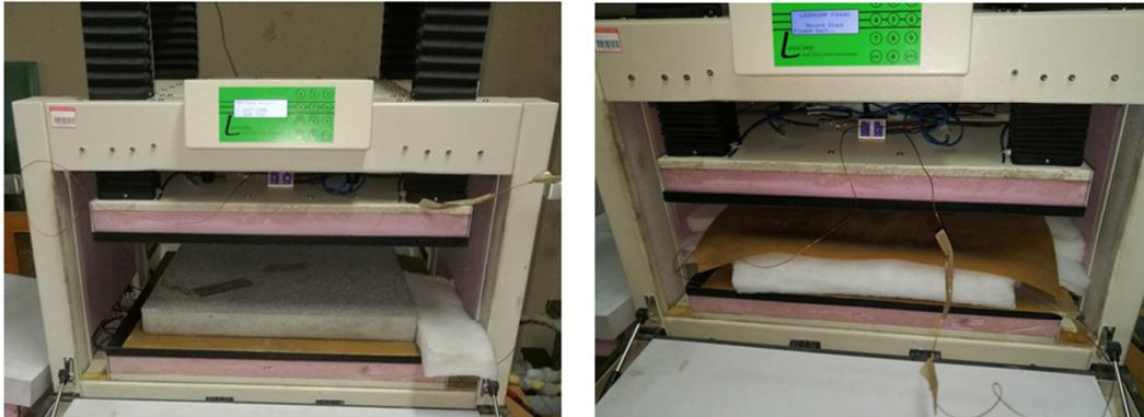
Figura 3.47: preparazione campione cementizio inserito nel flussimetro (foto autoprodotta)
