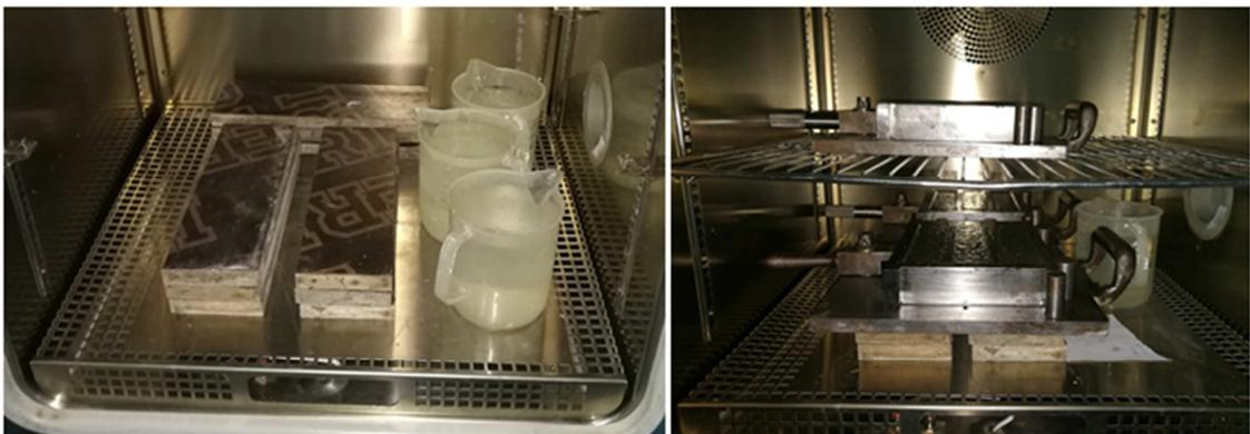
Figura 3.25: mantenimento ambiente umido camera climatica (foto autoprodotta)
