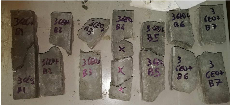
Figura 3.28: rottura campioni, miscela n. 3 (foto autoprodotta)
