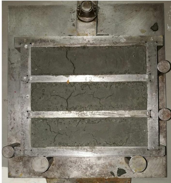
Figura 3.26: fessurazioni, miscela n. 3 (foto autoprodotta)
