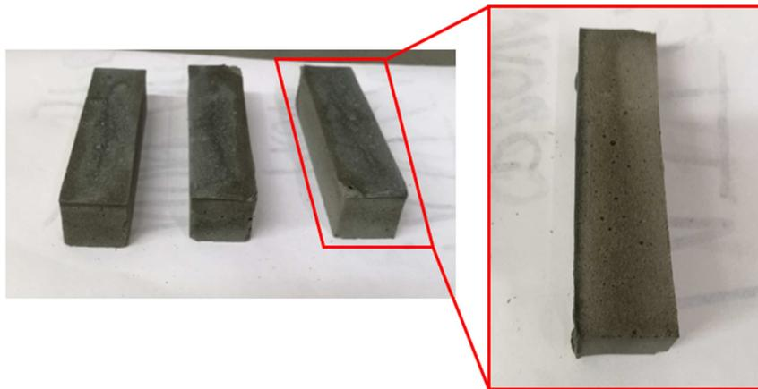
Figura 3.14: risultato campioni per test nuova composizione (foto autoprodotta)
