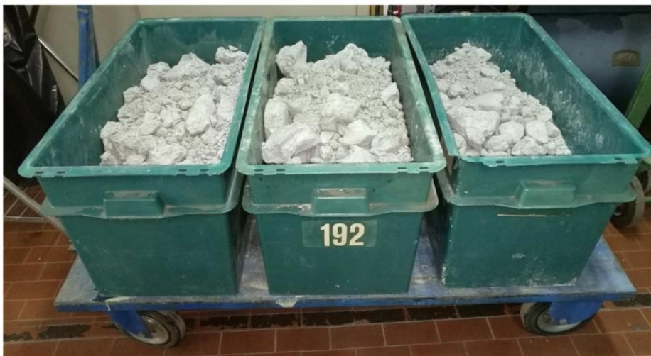
Figura 3.4: conglomerato fangoso a base di polvere lapidea (foto autoprodotta)
