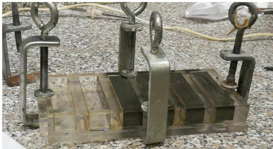
Figura 3.13: preparazione campioni per test nuova composizione (foto autoprodotta)
