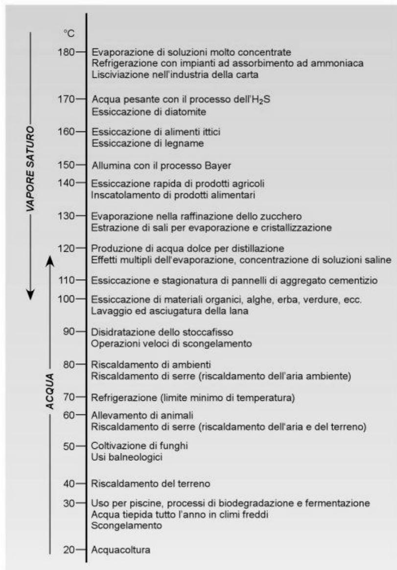
Figura 1.14: applicazioni della risorsa geotermica in base al livello entalpico (Lindal B. 1973)
