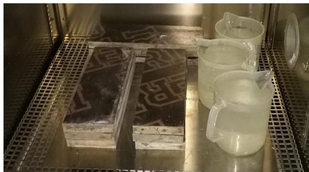
Figura 3.50: tecnica per il mantenimento dell'ambiente umido (foto autoprodotta)
