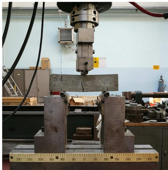
Figura 3.55: prova a flessione su 3 punti (foto autoprodotta)
