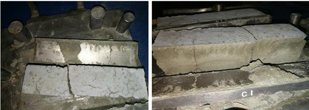
Figura 3.20: materiale adesivo alla cassaforma, campioni miscela n. 2 (foto autoprodotta)
