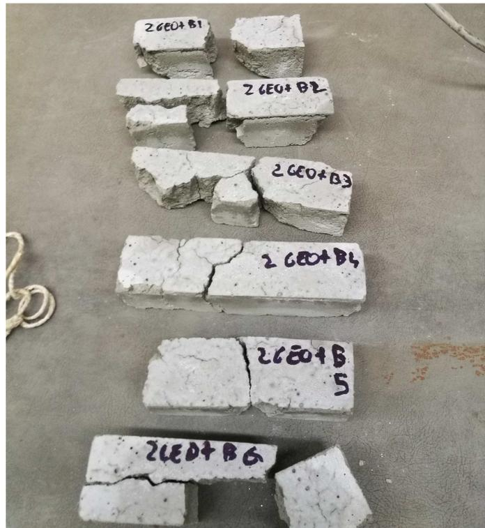
Figura 3.30: stagionatura a temperatura ambiente, miscela n. 2 (foto autoprodotta)
