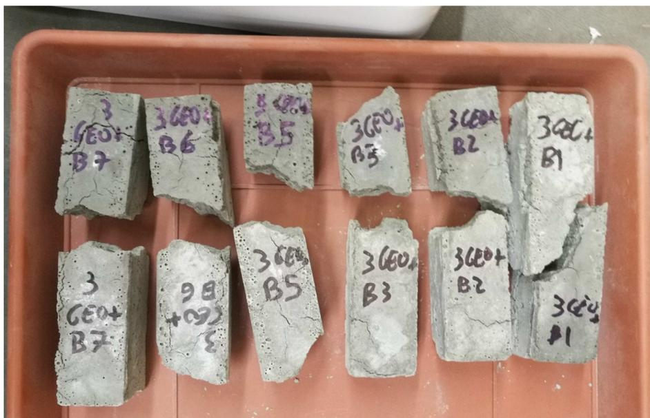
Figura 3.29: parti sottoposte al nuovo ciclo termico, miscela n. 3 (foto autoprodotta)
