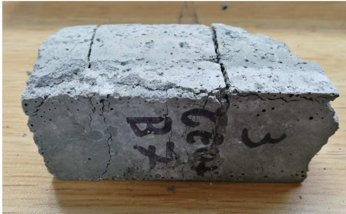
Figura 3.58: prova a compressione miscela n. 3
