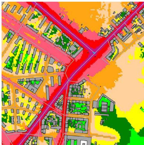
Curve di isolivello di  $L_{\text{notturno}}$ . (Altezza 4m)
