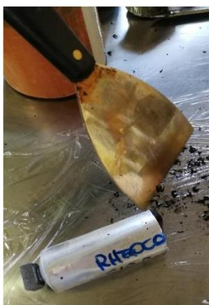
Figura 2.2 Cilindro di alluminio con all'interno bitume e spatola utilizzata per il taglio
