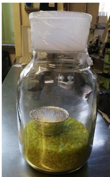
*Figura 2.6 Campana di vetro per il raffreddamento del materiale essiccato*
