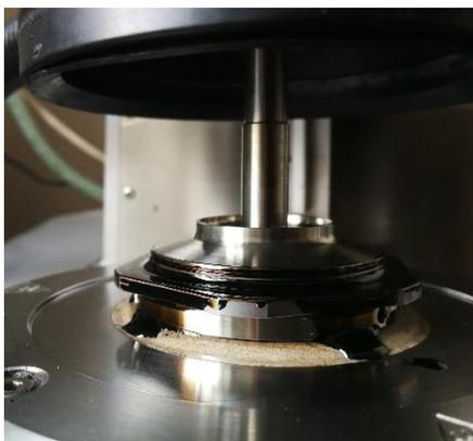
Figura 3.5 Fuoriuscita di bitume, prova con PP-50 su solo bitume
