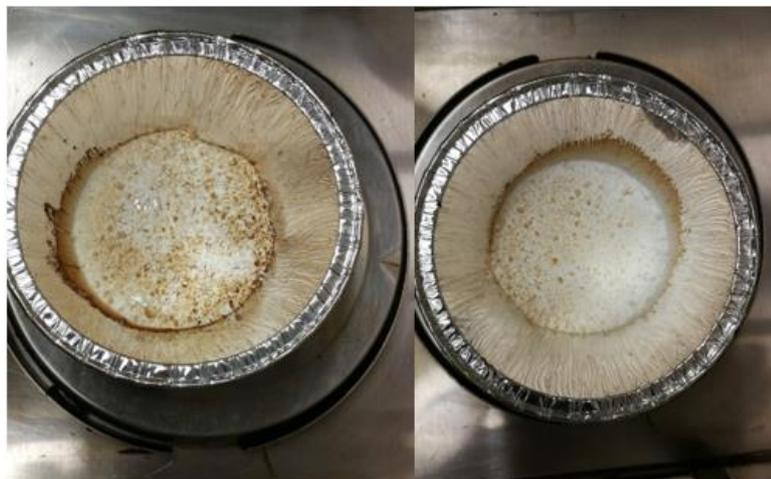
Figura 2.12 ZeoliteY Ammonium e ZeoliteY Sodium post essiccazione a 200 °C
