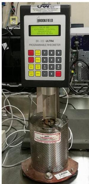
Figura 2.1 Viscosimetro Rotazionale Brookfield DV-III ULTRA
