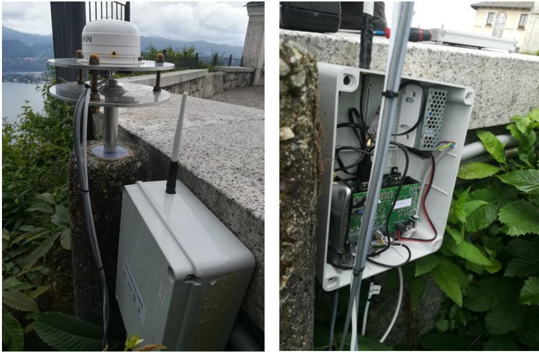
Figura 3: Sistema di monitoraggio realizzato a Madonna del Sasso
