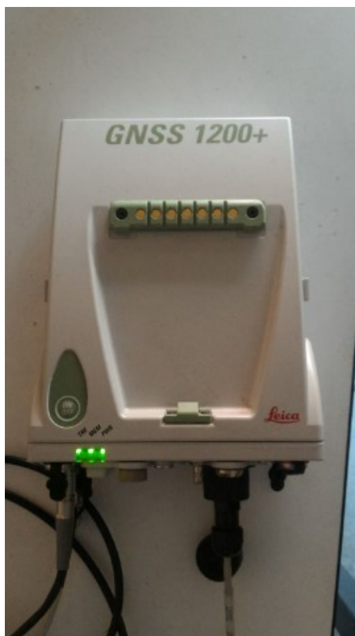
Figura 22: ricevitore geodetico multi frequenza e multi costellazione GPS, GLONASS e GALILEO Leica GRX1200 + GNSS
