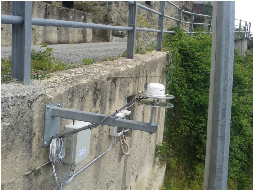
Figura 4: Sistema di monitoraggio con staffa e antenna GARMIN realizzato a Loreglia
