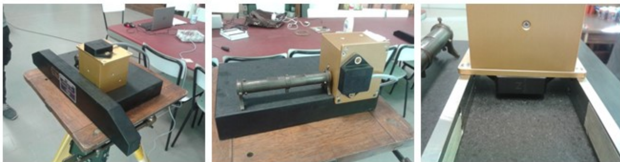
Figura 42: calibrazione inclinometro 4030 – misure sulle 6 facce
