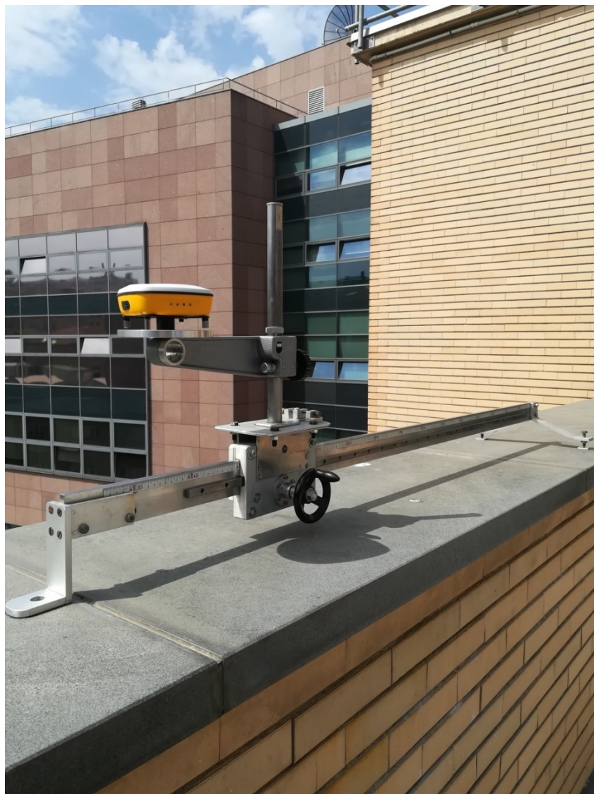
Figura 15: Posizionamento cinematico con slitta e ricevitore geodetico RUIDE S680P
