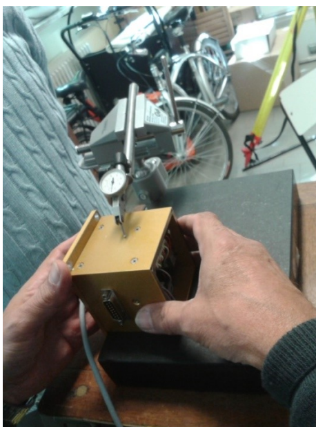
Figura 41: verifica planarità e ortogonalità del supporto meccanico per il test delle 6 facce
