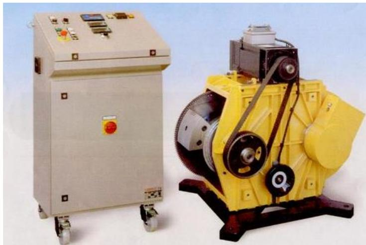
**Figura 4.2:** Vibrodina elettro-meccanica dotata del relativo motore di trascinamento e dei sensori di misura di frequenza e fase e di un quadro elettrico (a sinistra della foto – contenente il sistema di controllo della velocità di rotazione).
