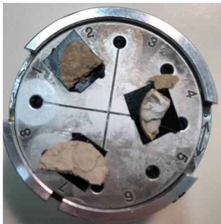
Fig.3.13 - Ruota portacampioni con tre materiali prima dell'analisi (facoltà di geologia, Torino)
