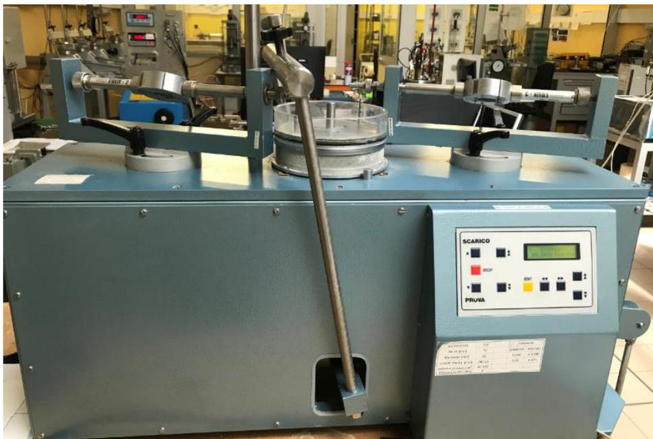
Fig. 3.18 – apparecchio di taglio anulare, Bromhead Ring Shear
