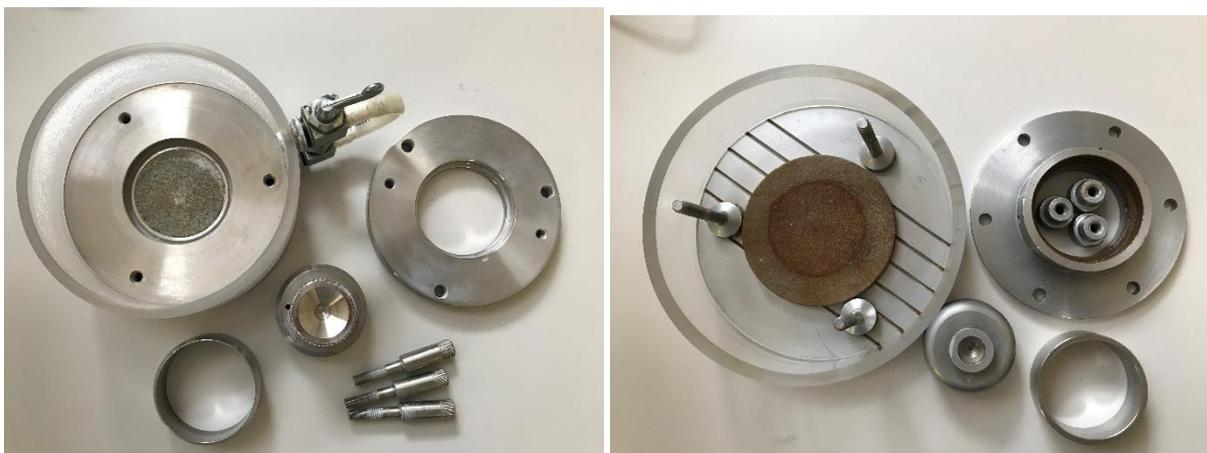
Fig.3.24 - celle di carico edometriche: Tecnotest (a sinistra) e Wikeham-Farrance (a destra)
