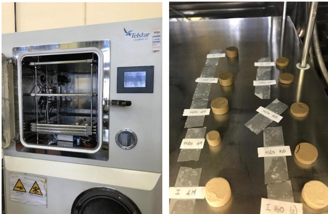
Fig.3.10 - Liofilizzatore del DISAT e posizionamento dei campioni all'interno di esso
