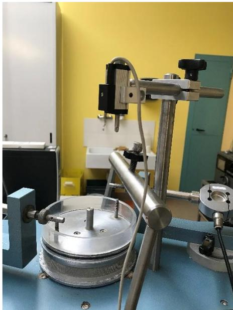
Fig. 3.20 - cella di carico e trasduttori
