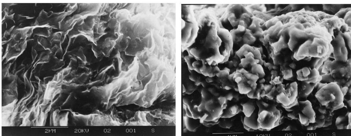
Fig.2.5 – analisi SEM, bentonite di Ponza saturata con soluzioni di NaCl (a sinistra) e KCl (a destra) e poi sottoposta ad acqua distillata. (Di Maio, 1996)
