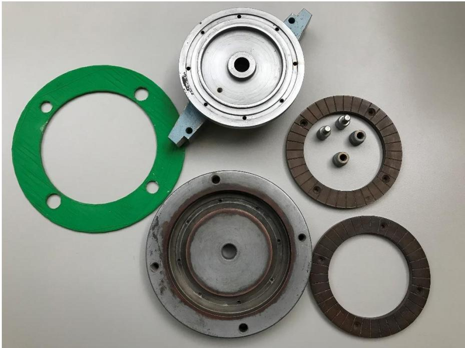
Fig. 3.19 - componenti cella di taglio anulare
