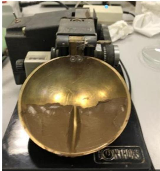
Fig.3.16 - Cucchiaio di Casagrande e intaglio nel materiale (bentonite)
