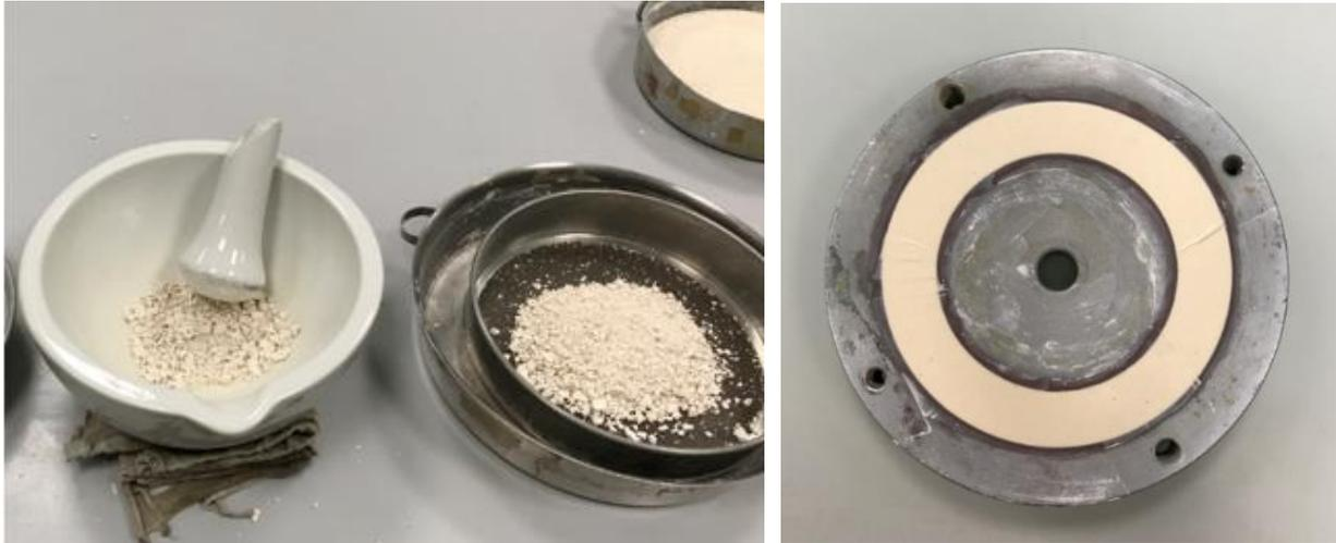
Fig. 3.21 – pestellatura del materiale (a sinistra) e riempimento della piastra inferiore (a destra), (illite)
