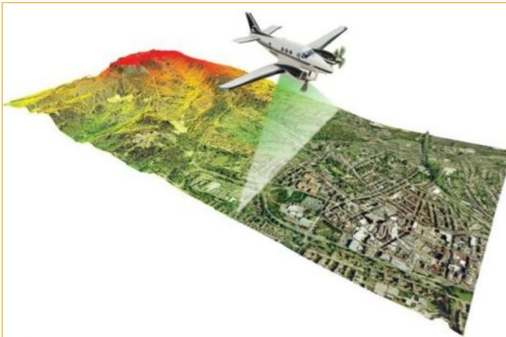
Figura 4.2 rappresentazione tecnologia LIDAR
