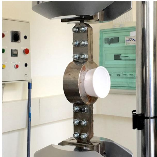
Fig. 5.6(6) il campione, le piastre, l'anello, il bicchiere e i bulloni sono montati nella macchina di prova di trazione prima del precarico
