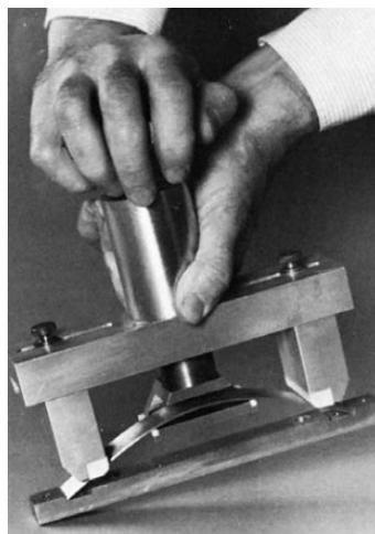
Fig. 4.1.2. Stressing jig per campione caricato a due punti
