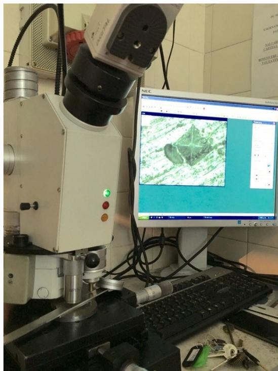
Fig. 5.4(4) Misurazione di durezza Vickers
