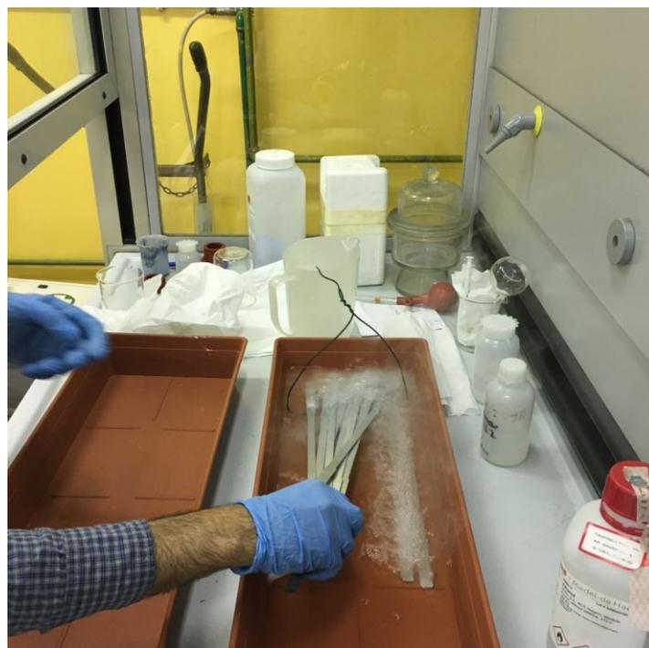
Fig. 5.5(3) Dezincatura dei campioni con sviluppo di  $H_2$
