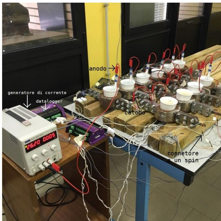
Fig 5.7(4) Banco di prova per corrosione a corrente catodica
