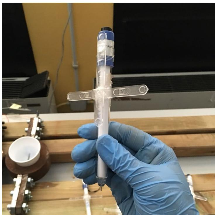
Fig. 5.7(3) Elettrodo inerte assemblato con palette per caffè
