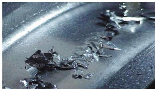
**Figura 3.1:** fenomeno di usura su superficie di rotolamento della ruota.
