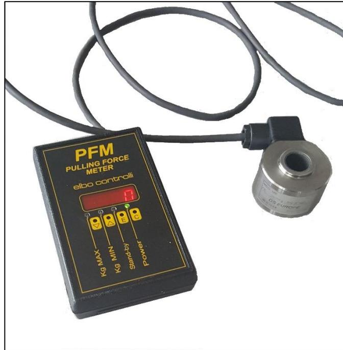
Figura 2.5- Strumento di misurazione elettronica delle forze.
