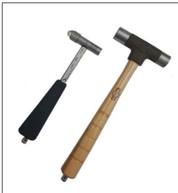
*Figura 4.4- Martelli strumentati con diverse masse eccitatrici.*
