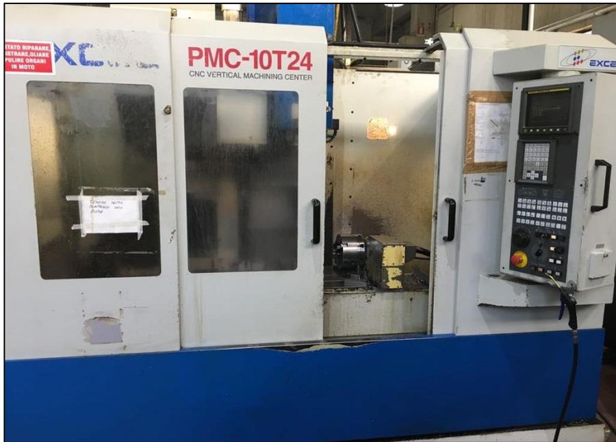
Figura 5.2- Centro di lavoro verticale utilizzato nella prova.
