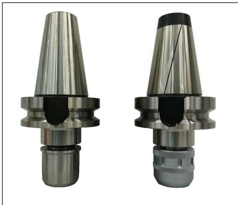
*Figura 3.1- Differenza reale tra un portautensile BT standard e un BT a triplo contatto.*
