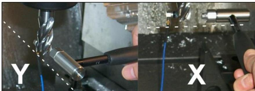
Figura 4.11- Posizione del martello e dell'accelerometro durante l'impatto.
