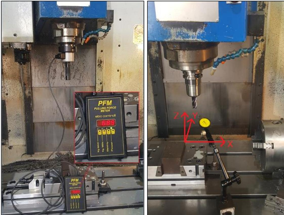
Figura 5.3- a) Verifica del tiraggio del mandrino mediante il misuratore di forza di trazione con cella di carico incorporata e lettore digitale. b) definizione dello zero pezzo (destra)
