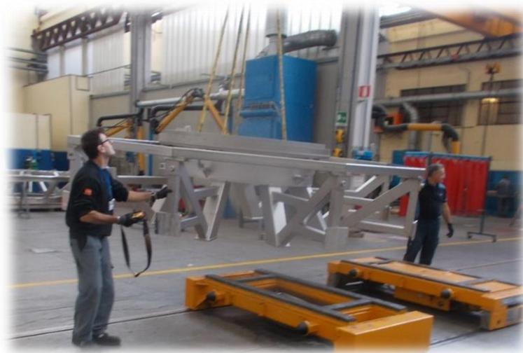
**Figura 49.** Impiego di due operatori per movimentazione del componente
