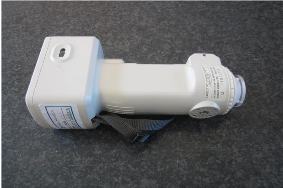
Fig.20: Immagine di uno spettrofotometro
