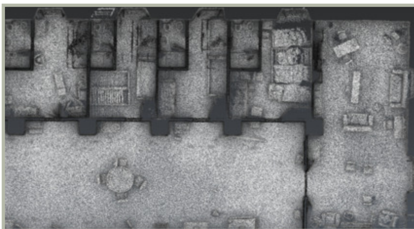
Fig. 3 Si tratta di una vista orizzontale di una parte del corridoio e di alcune camere, tratta dal file relativo al rilievo effettuato con tecnologia SLAM del convento. E' immediatamente leggibile la scansione fra i vuoti ed i pieni, il che permette di individuare l'ossatura dell'edificio, la profondità delle finestre, eventualmente anche la disposizione dei mobili.
