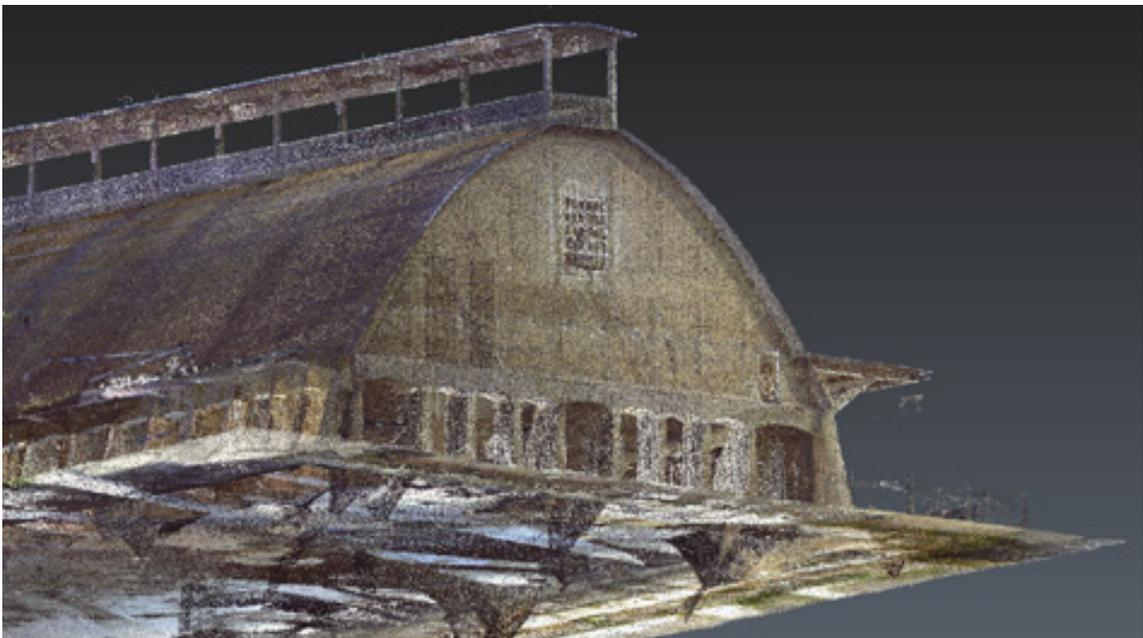
Nuvola di punti completa del Paraboloide ottenuta dalle scansioni dei lavori del 2012.
