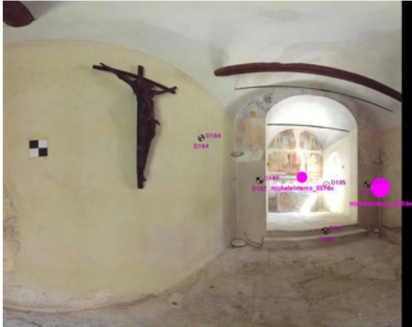
Visualizzazione planare di una nuvola di punti della cappella di San Michele in Novalesa, con l'identificazione dei marker. Software FARO Scene. Fonte: Foto dell'Autore.
