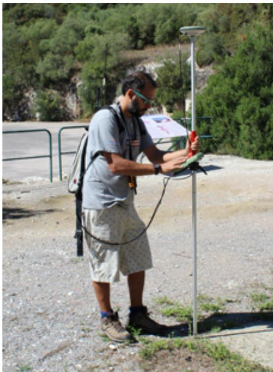
Sopra: ricevitore GNSS in metodo statico. Fonte: Foto dell'autore
