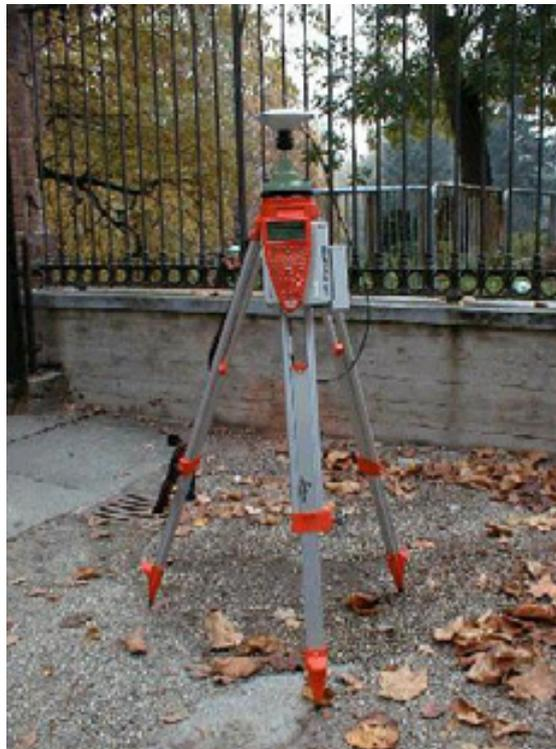
Sopra: ricevitore a corpo fisso e comando esterno portatile. Fonte: Foto dell'autore
