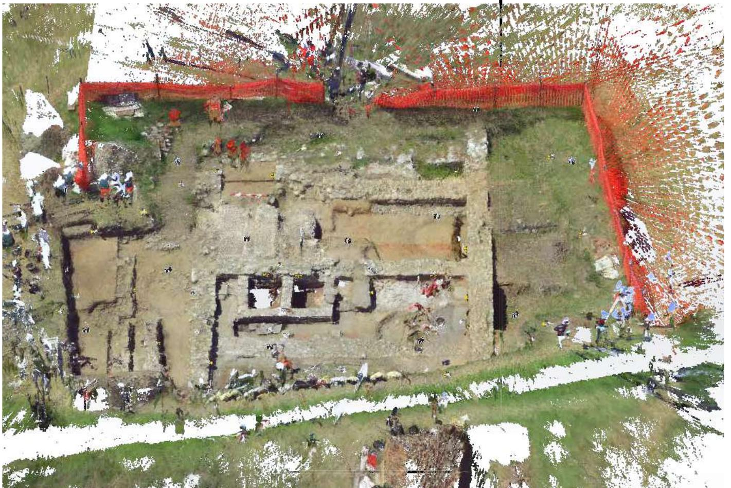
Fig.9: Scansioni registrate per forma e target, nuvola densa colorata
