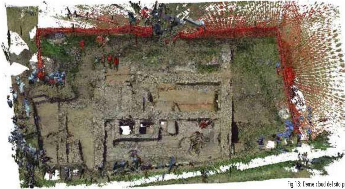
Fig. 13: Dense cloud del sito prodotto attraverso il metodo laser scan
