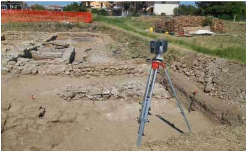
Fig. 14: Fase di acquisizione delle nuvole mediante strumentazione Laserscan Focus X 130
