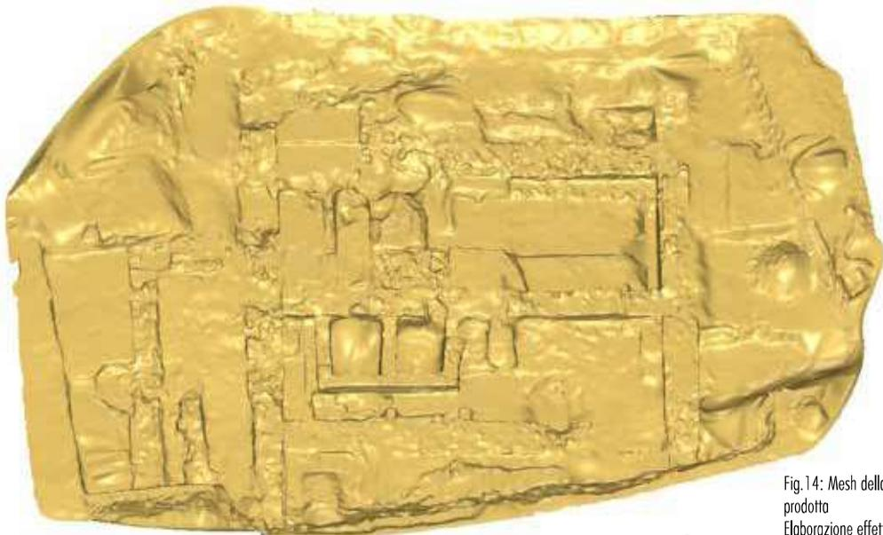
Fig. 14: Mesh della dense cloud precedentemente prodotta
