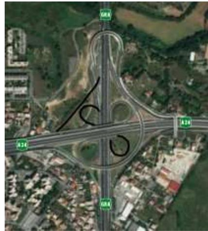
Figura 47 – Elaborazione propria. In nero si evidenzia il precedente svincolo dell'uscita n.14, L'Aquila – Teramo.
