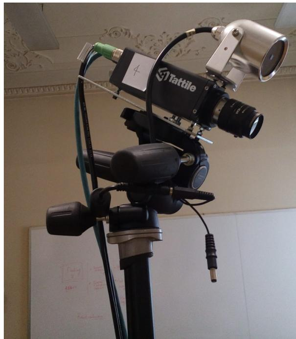
*Figura 7* Telecamera equipaggiata con illuminatore IR e ottica con filtro IR
