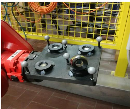
*Figura 16 Piastra con marker ed SMR fissata al braccio robotico*
