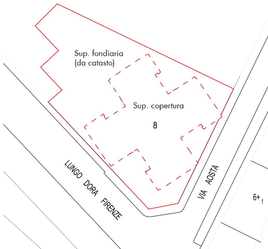
Fig. 104 : Disegno illustrante il rapporto di copertura esistente sul lotto di Lungo Dora Firenze 19.
