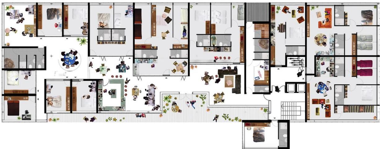
*Fig. 8 : Intervento su un immobile esistente per trasformarlo in Co-residenze. Utilizzo del sistema distributivo per creare spazi comuni.*
