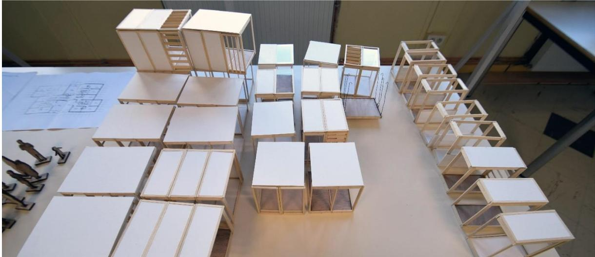
*Fig. 51: I modelli in scala 1:20 dei moduli da sovrapporre alla facciata e al tetto dell'edificio*
