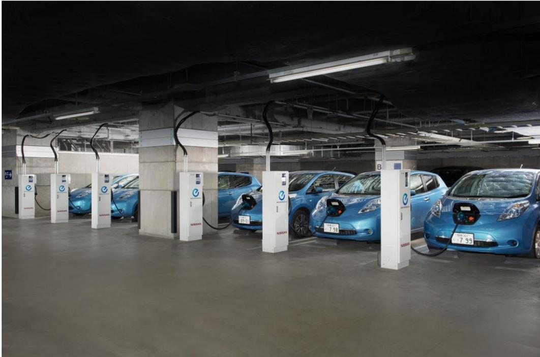
**Figure 60. Vehicle-to-Building presso gli uffici del NATC. Lo scambio di energia avviene grazie al collegamento di sei Nissan LEAF elettriche.**
