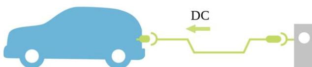
La ricarica in modo 4 è un sistema di ricarica veloce in corrente continua (fast DC). Sono previste potenze più elevate rispetto a quelle in alternata (ad oggi hanno una
