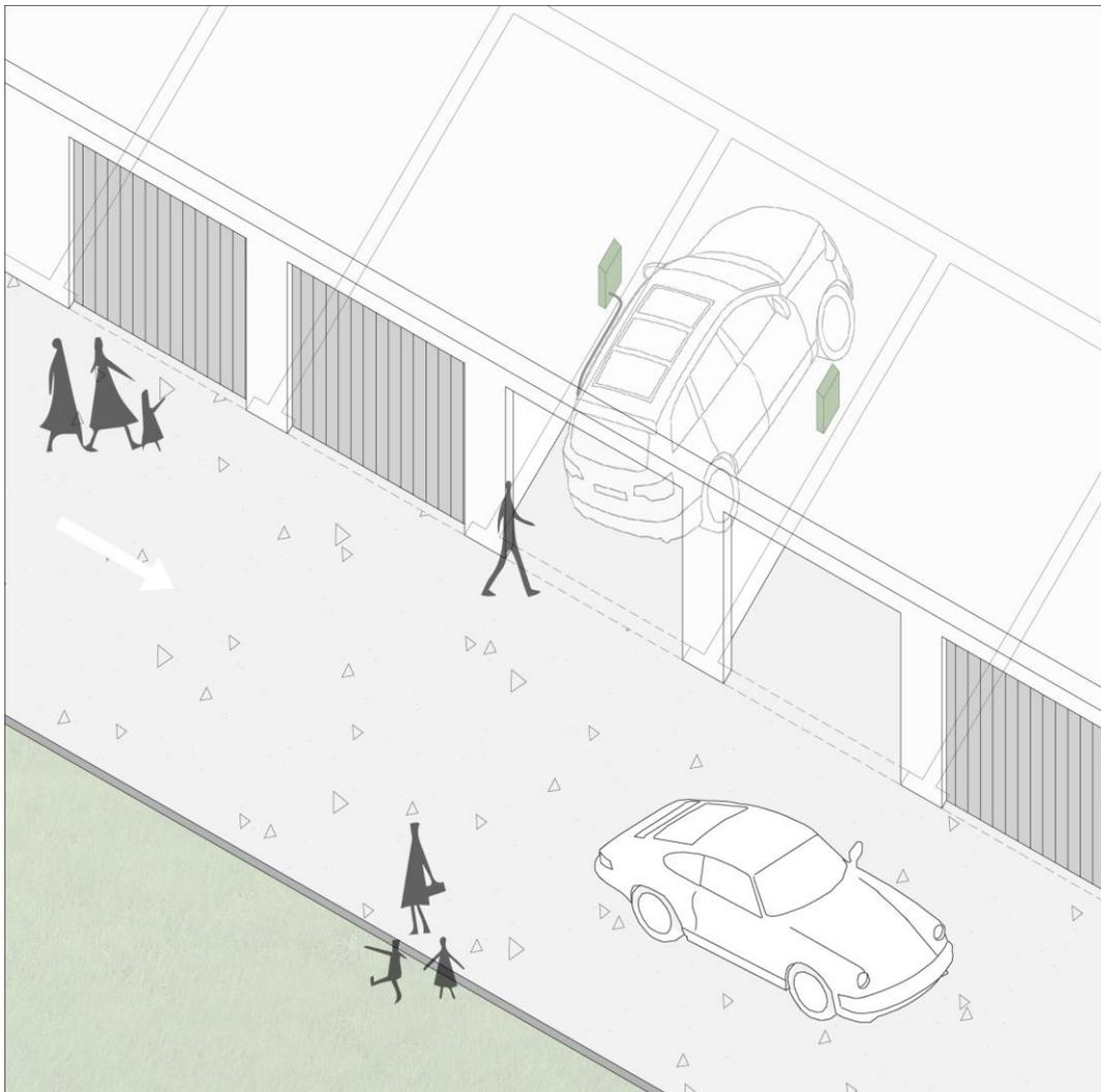
**Figure 57. Tipo 4: Parcheggio privato in box auto. La “Wall Box” dovrebbe essere a lato per semplificare la ricarica di tutti i tipi di veicoli.**
