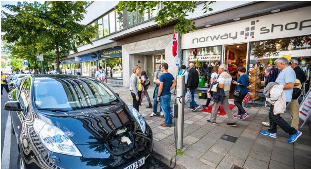
**Figure 53. Colonnina di ricarica su bordo strada ad Oslo. La larghezza del passaggio pedonale è sufficiente per permettere l’integrazione delle colonnine, della segnaletica, dell’illuminazione e del verde urbano.**
