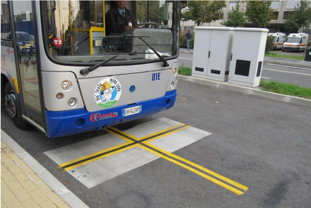
Figure 24. Sistema di ricarica induttivo per autobus elettrici. Torino
