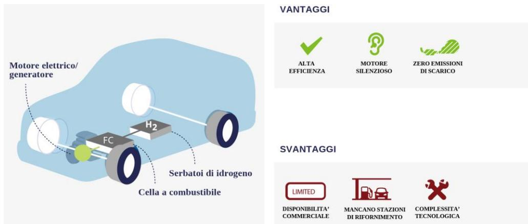
Figure 14. Veicoli a Fuel-cell a idrogeno (FCEV). Vantaggi e svantaggi. Fonte: European Environmental Agency (EEA)
