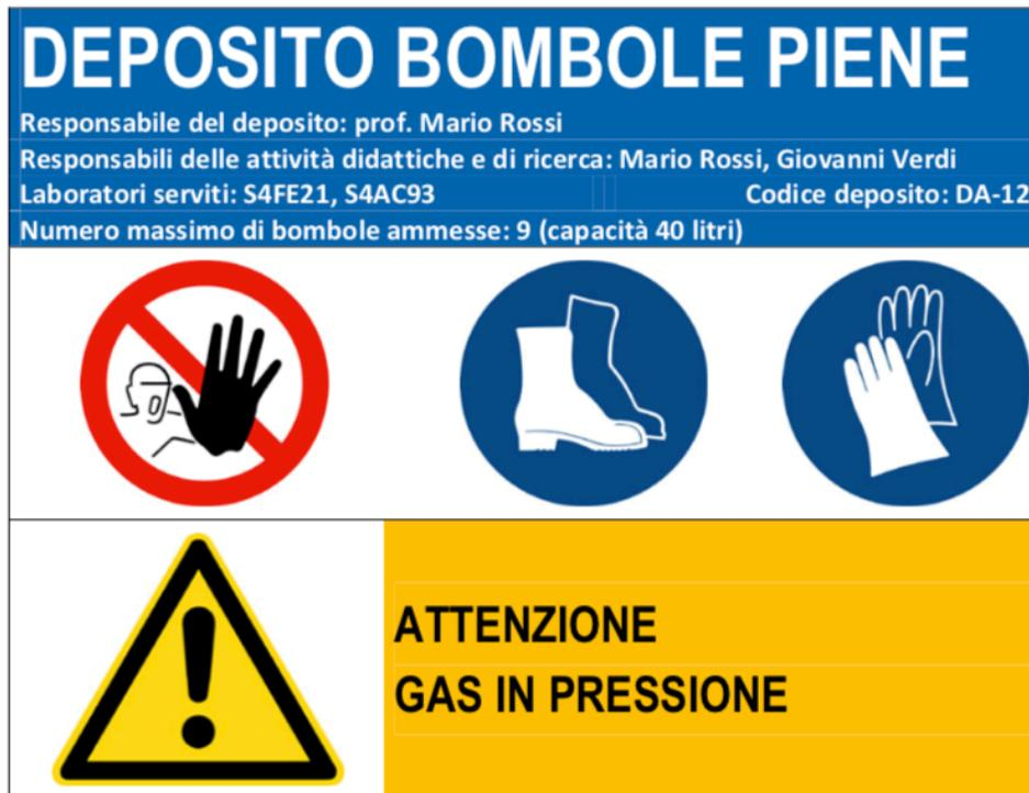
Figura 69: Esempio di segnaletica per un deposito d'uso di gas inerti/bombole di aria in pressione [40]
