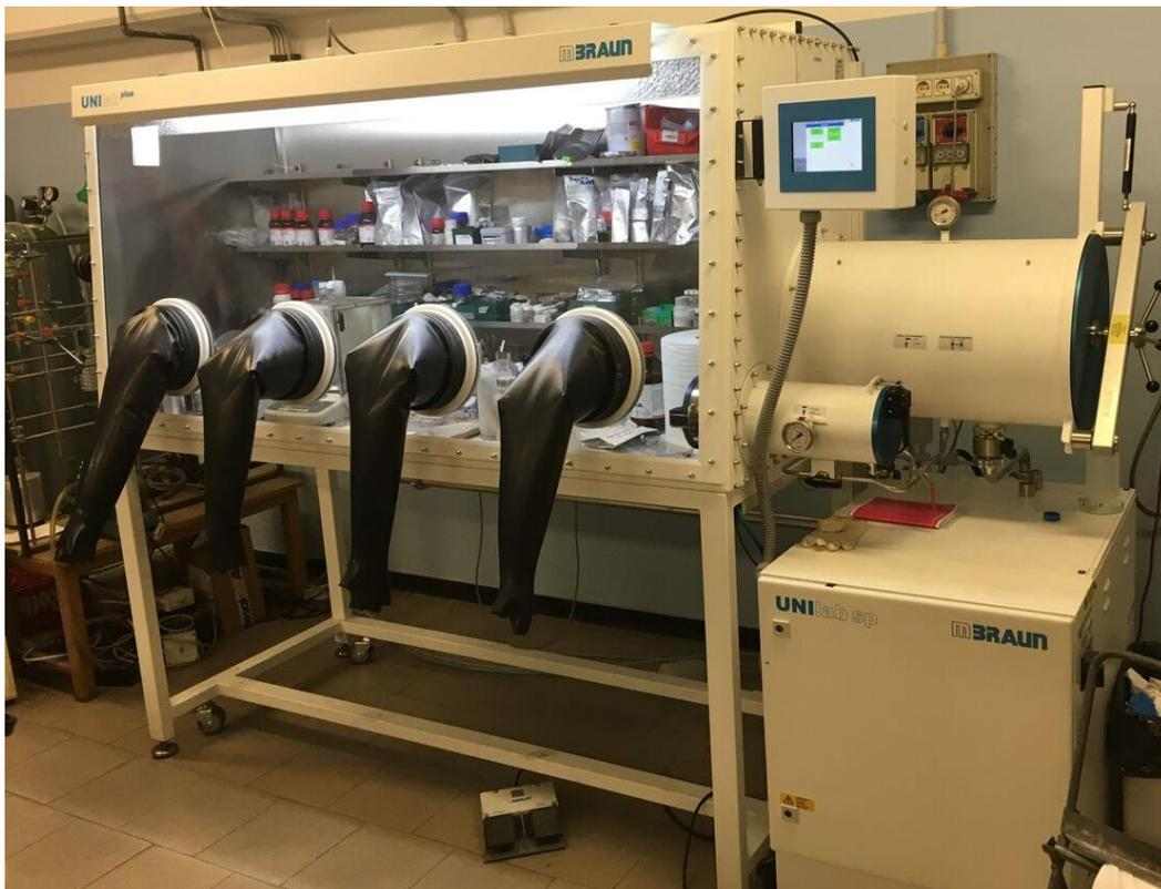
Figura 6.7 Glove box all'interno del quale sono state fabbricate le celle
