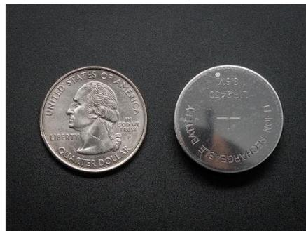
Figura 6.5 Esempio di coin-cell
