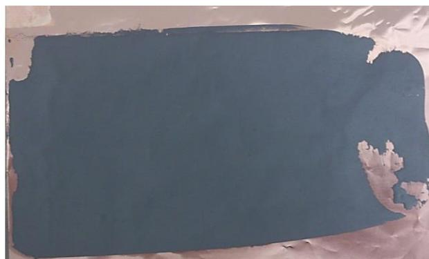
Figura 6.4 Esempio di elettrodo dopo la stesura del materiale attivo.
