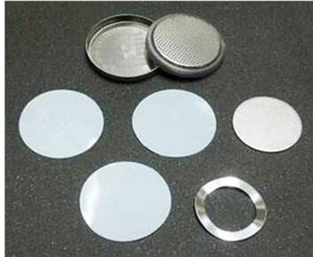
Figura 6.6 Fotografia di componenti principali della coin cell: cap maschio e femmina (in alto), esempio di tre spacer in metallo (al centro a sinistra), del separatore in fibra di vetro (in centro a destra) e dello spring (in basso a destra)
