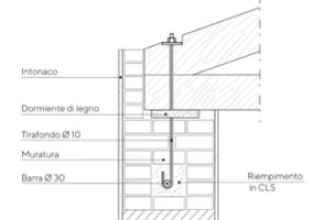
Creazione di un cordolo murario armato con barra f. 30 per l'ancoraggio mediante coppie di tirafondi Ø 10 delle capriate.
