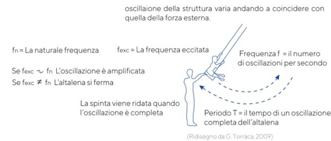
(fig.61) Spiegazione della risonanza mediante l'esempio dell'altalena di G. Torraca, 2009
