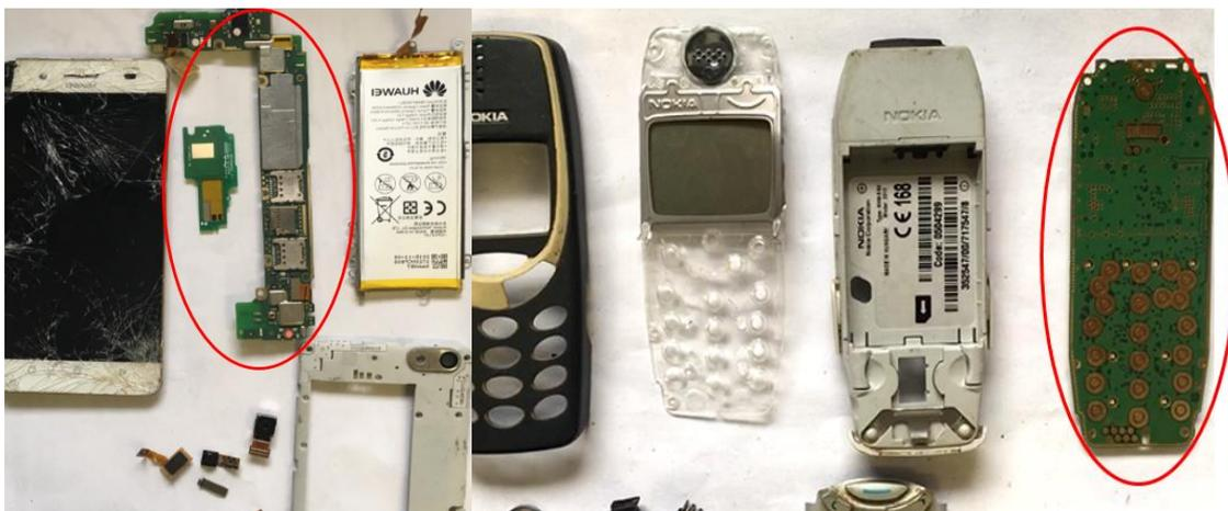
*Figura 23 e Figura 24: Immagini relative alla diversa dimensione di PCBs contenute all'interno dei dispositivi, cerchiare in rosso. A sinistra per lo Smartphone, a destra per il Cellphone.*
