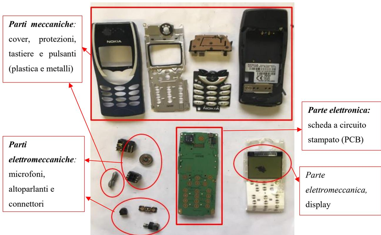
*Figura 17: Identificazione delle componenti di un telefono cellulare*
