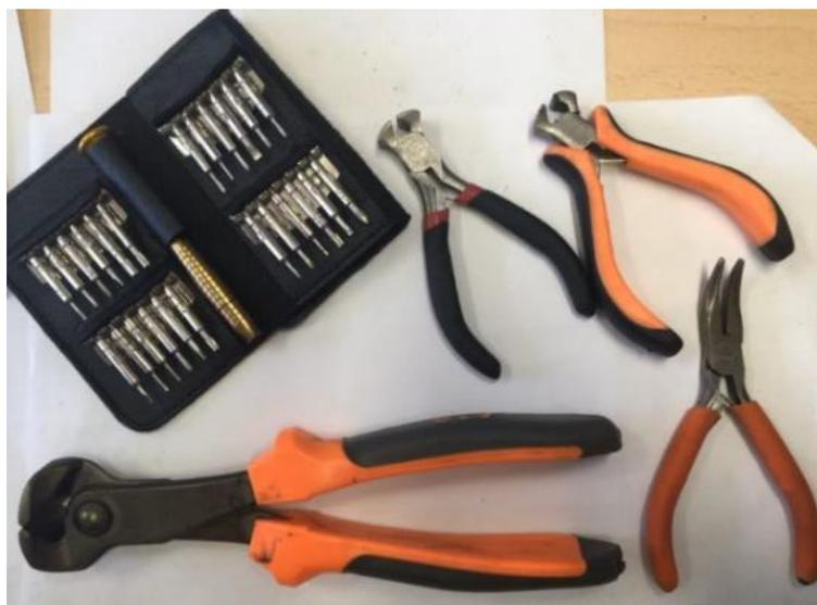
*Figura 16: Strumenti utilizzati per lo smontaggio dei dispositivi*
